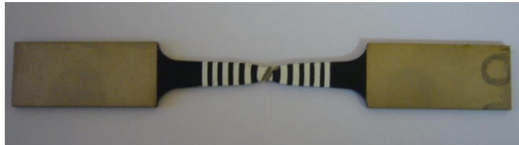
Figure 2-4. Eprouvette de traction de titane commercialement pur après la rupture. On note qu'il n'y a pas de rotation des bandes peintes.
