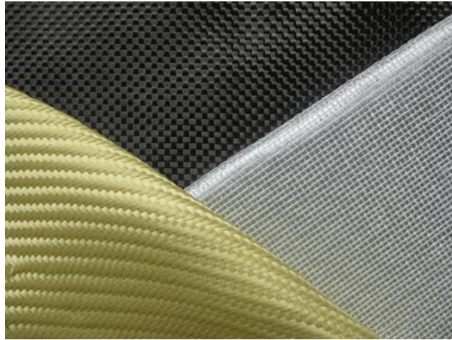
Figure 19 : Tissés de renforts synthétiques de carbone, de verre et de kevlar.
