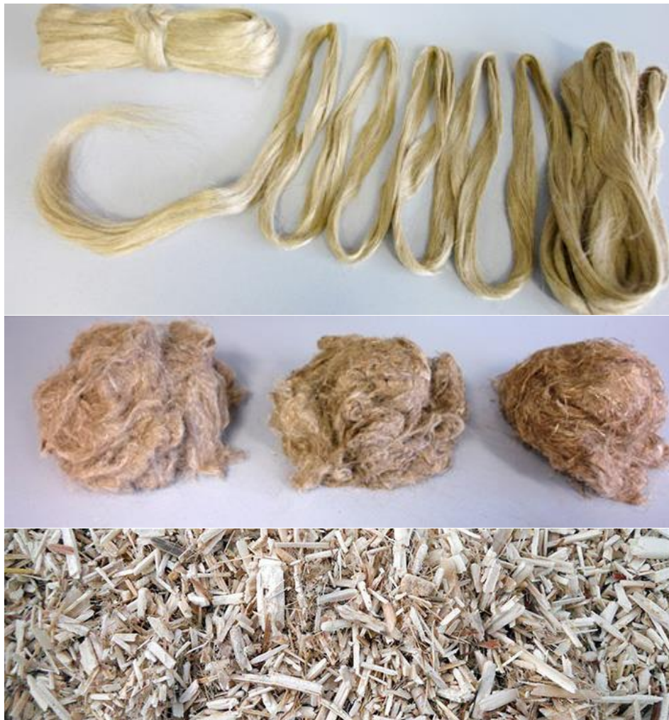
Figure 18 : Principaux produits issus de la culture du lin, de haut en bas, Fibres longues, étoupe et anas.
