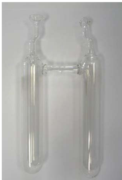
Figure 36 : Piège utilisé pour échantillonner les produits lourds au cours des expériences effectuées en mode d'échantillonnage discontinu.
