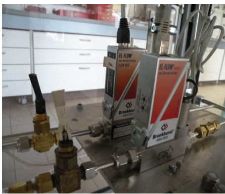
Figure 32 : Photographie des débitmètres de gaz Bronkhorst.
