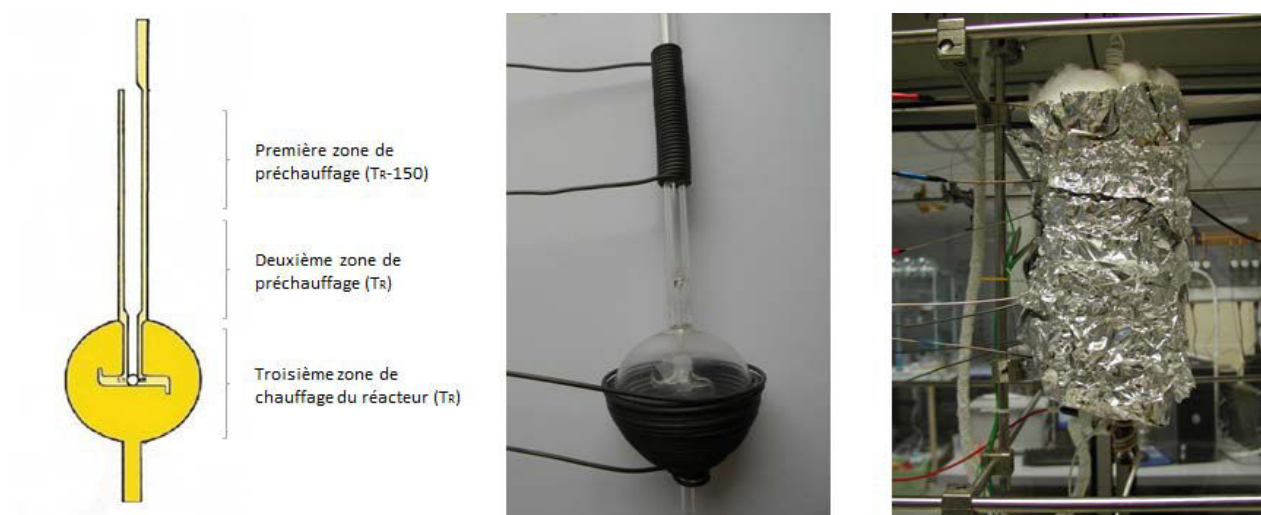
Figure 35 : Réacteur parfaitement agité (à gauche) montrant les zones de chauffage ; photographie des résistances chauffantes et du système d'isolation.
