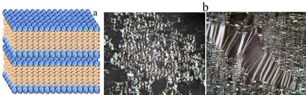
Figure I-3 – Représentation schématique d'une phase lamellaire L\alpha (a) et de sa texture caractéristique observée en microscopie optique sous lumière polarisée (b).
