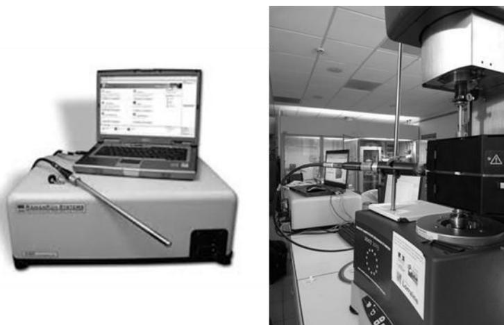
Figure 2.4 Spectromètre RXN1 Kaiser© et montage rhéo-raman
