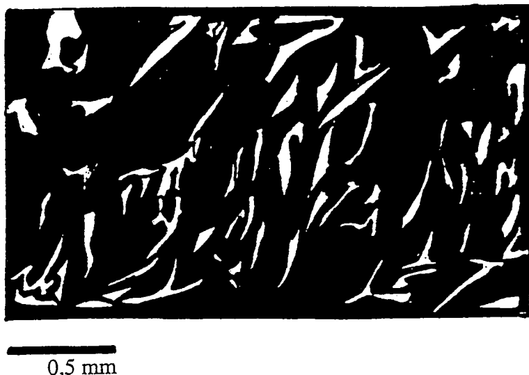
Fig. 3.5. Minrai de chromite à texture massive. Les fractures sont remplies de serpentine. Elles correspondent à des figures d'extension en "pull apart".
