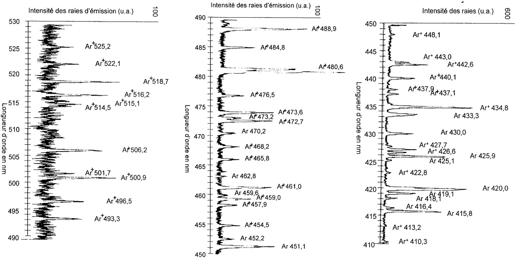
**Figure II.2 :** Spectre total d'émission optique réalisé dans l'argon pur ( $I$  Anode circulaire =  $I$  Anode cylindrique = 120 A,  $P_{enceinte} = 0,4$  Pa,  $T_{résistance} = 500^{\circ}\text{C}$ ).
