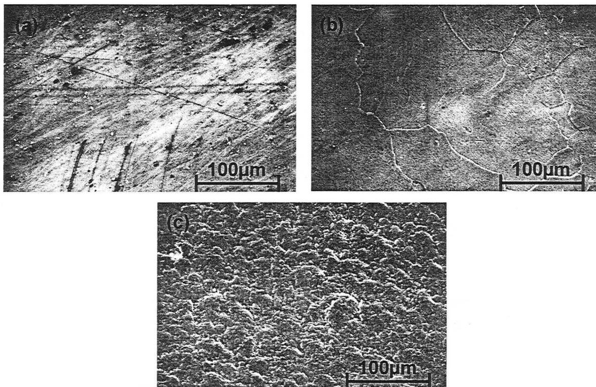
**Figure IV.13 :** Micrographies de surface obtenue par microscopie à balayage sur différents échantillons d'aluminium 99,99% (a) non traité, (b) décapé et (c) nitruré selon la procédure décrite dans le **Tableau IV.7**.
