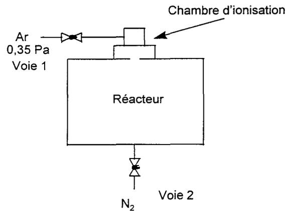
Figure II.25 : Répartition des gaz dans le réacteur
