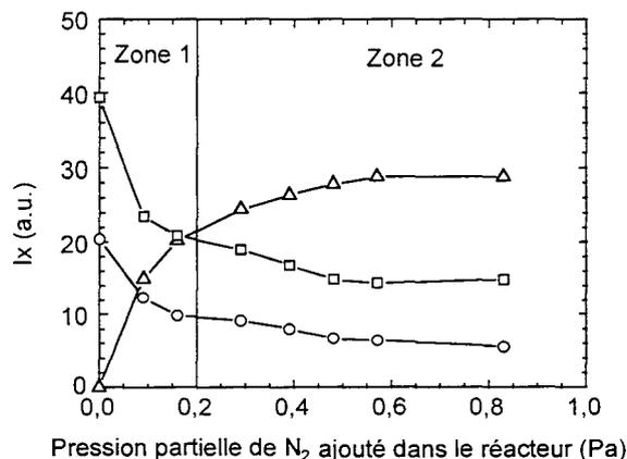
Figure II.29 : Evolution de l'intensité des raies de ( $\Delta$ )  $N_2^+$ , ( $\square$ )  $Ar^+$ , ( $\circ$ )  $Ar$  en fonction de la pression partielle d'azote ajoutée dans le réacteur ( $P_{Ar} = 0,35$  Pa, 120 A sur chaque anode).
