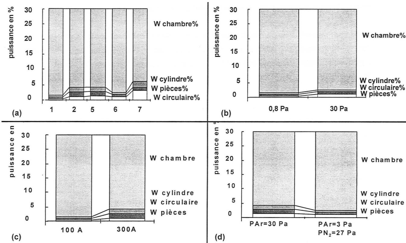
**Figure 7 :** Répartition des puissances au sein du réacteur.
