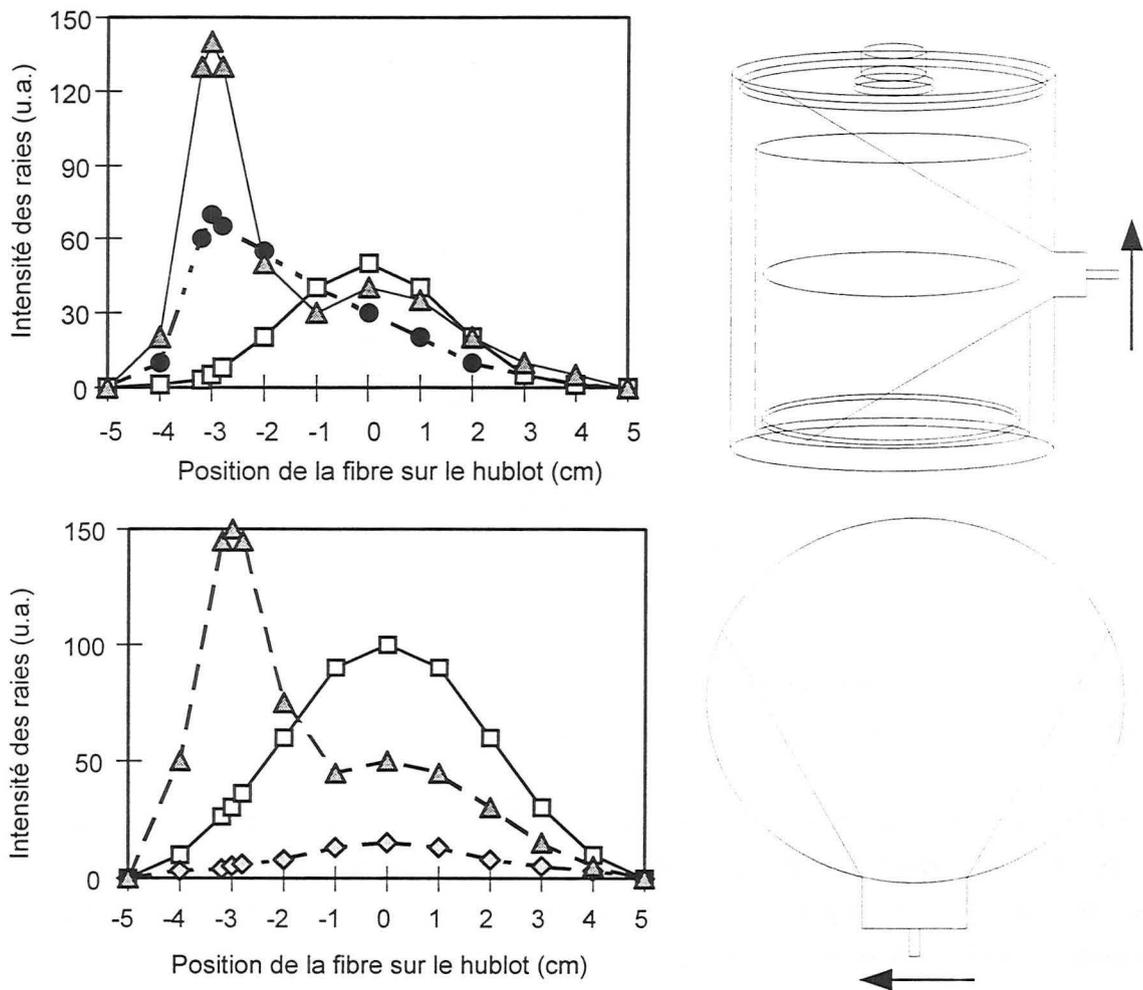
**Figure 2 :** Mise en évidence du faisceau primaire par spectroscopie d'émission optique. (□) Ar, (●)  $\text{Ar}^+$ , (◇)  $\text{N}_2^+$ , (▲) H. (a fibre optique est déplacée linéairement et perpendiculaire à la fenêtre d'observation, mélange Ar-50%  $\text{N}_2$ , 120 a sur chaque anode, 0,4 Pa d'argon dans la chambre d'ionisation).
