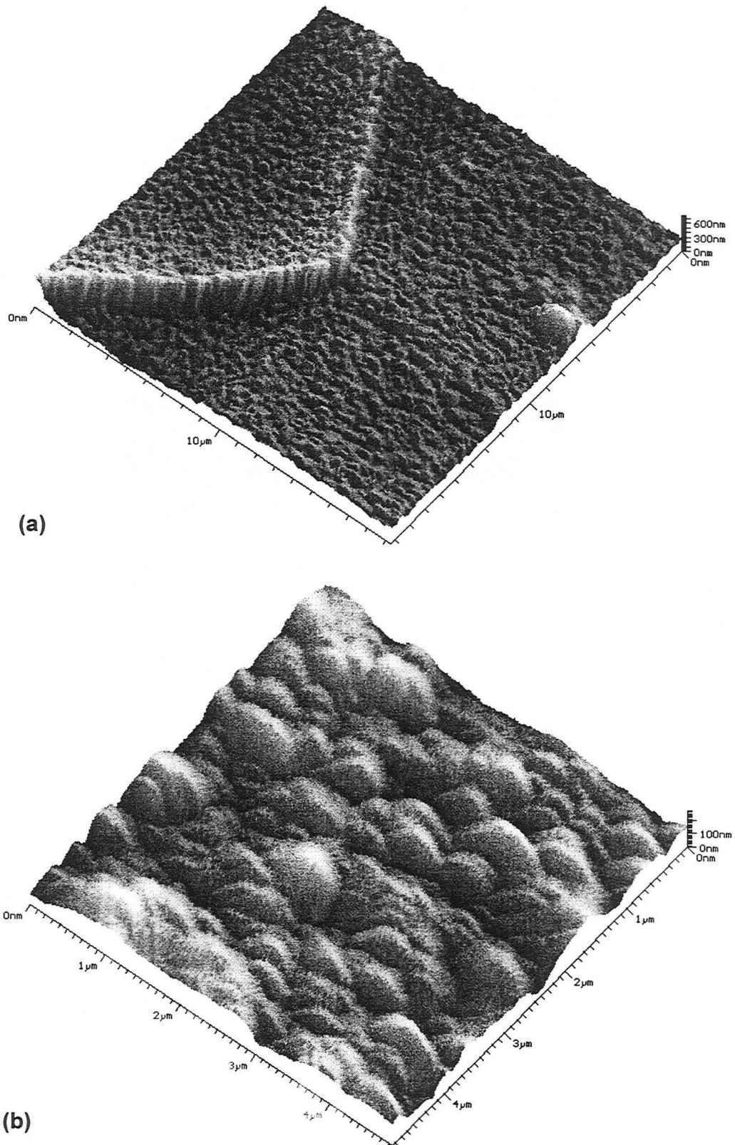
**Figure III.8** : Image en trois dimensions effectuée par microscopie à force atomique (AFM) de la surface d'un échantillon en acier inoxydable austénitique AISI 316L nitruré selon la **procédure 2** du **Tableau III.4**; (a) jonction entre trois grains, et (b) image à haute résolution de la morphologie de surface d'un grain.
