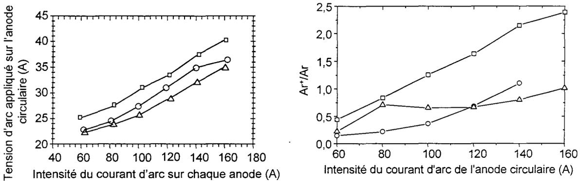
**Figure II.14** : Evolution de la tension appliquée sur l'anode circulaire (a) et du rapport d'Intensité des raies d'émission Ar<sup>+</sup> / Ar (b) en fonction de l'intensité du courant d'arc pour différents diamètres de diaphragme (□) 6 mm, (○) 13 mm, (△) 20 mm à pression d'argon dans le réacteur constante et égale à 0,35 Pa.
