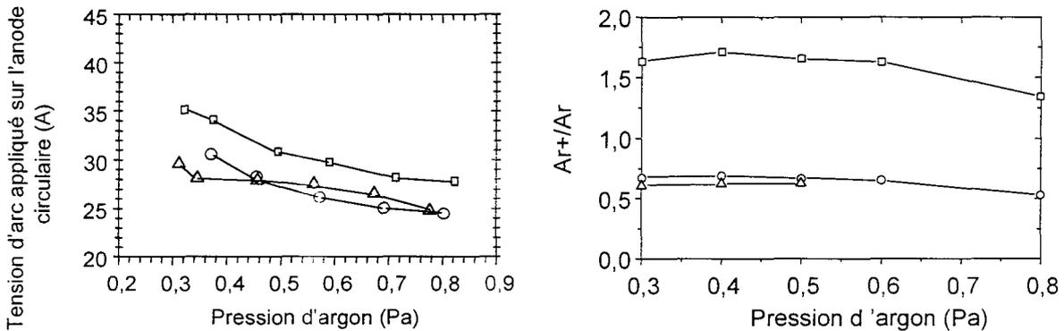
**Figure II.15** : Evolution de la tension appliquée sur l'anode circulaire (a) et du rapport d'Intensité des raies d'émission Ar<sup>+</sup> / Ar (b) en fonction de la pression d'argon (injection d'argon par la voie 1) pour différents diamètres de diaphragme (□) 6 mm, (○) 13 mm, (△) 20 mm. L'intensité du courant est égale à 120 A sur chaque anode.
