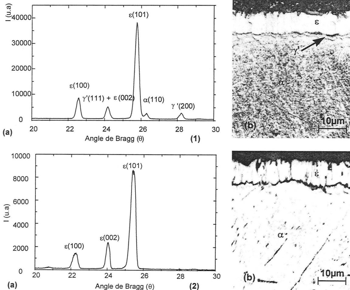
**Figure II.49** Echantillons en fer armco nitrurés dans un mélange (1) Ar-55%N<sub>2</sub> et 5 N cm<sup>3</sup> min<sup>-1</sup> de CH<sub>4</sub> et (2) Ar-55%N<sub>2</sub> et 8 N cm<sup>3</sup> min<sup>-1</sup> de CH<sub>4</sub>. (a) Cliché de diffraction des rayons X ( $\lambda$  K $\alpha$  Co = 0,17902 nm, 4°). (b) Coupe métallographique des échantillons. La structure est révélée par les réactifs Nital et Oberhoffer.
