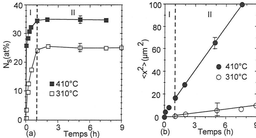
**Figure III.11 :** Evolution de la concentration superficielle en azote ( $N_s$ ) (a) et du carré de l'épaisseur de la couche de diffusion  $\langle x^2 \rangle$  (b) en fonction du temps de traitement de nitruration d'une série d'échantillons en AISI 316L nitrurés à  $310^\circ\text{C}$  ( $\square$ ) et  $410^\circ\text{C}$  ( $\blacksquare$ ).
