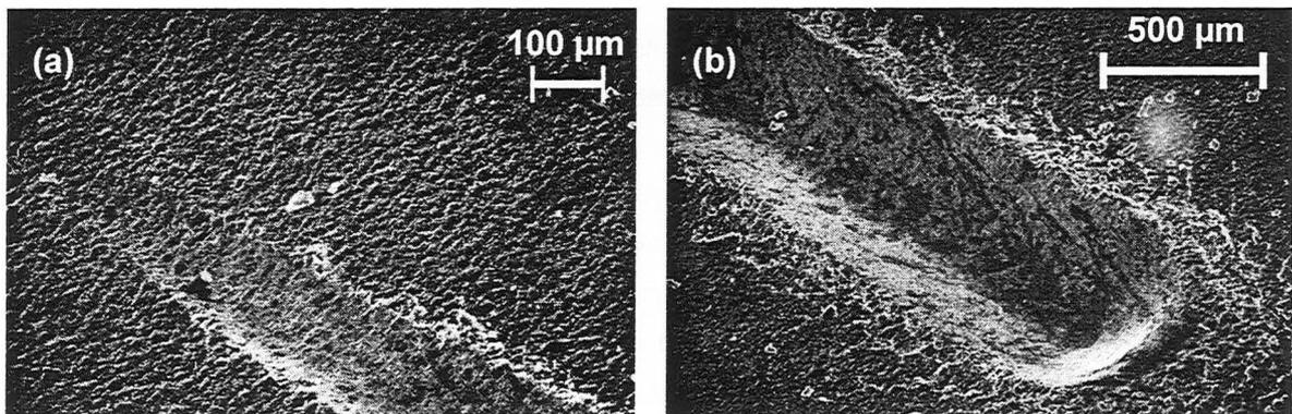
**Figure IV.20** : Micrographies de la rayure réalisée sous charge croissante de la couche nitrurée selon la procédure décrite dans le **Tableau IV.7**. (a) début de trace. (b) fin de trace.
