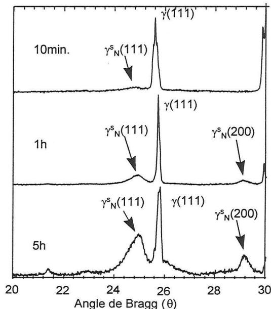
**Figure III.12 :** Clichés de diffraction des rayons X ( $\lambda$   $K_\alpha$  Co = 0.17889 nm,  $4^\circ$ ) réalisés à la surface de 3 échantillons en AISI 316L nitrurés respectivement pendant 10 min, 1h et 5h à  $310^\circ\text{C}$  selon la procédure 1 du **Tableau III.5**.
