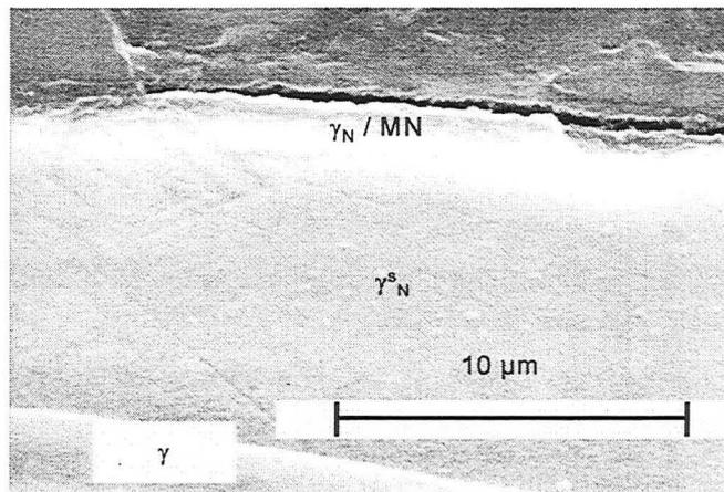
**Figure III.19 :** Coupe métallographique observée par microscopie électronique à balayage de l'échantillon en AISI 316L nituré pendant 7h30 mn (voir **Figure III.18**).
