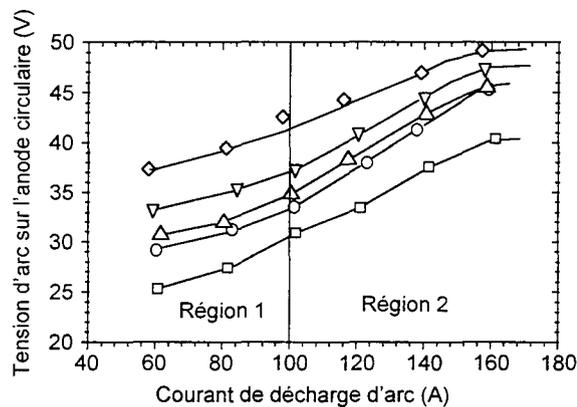
Figure II.26 : Caractéristique Courant - Tension de la décharge pour différents mélanges dans le réacteur (□) Ar (0,35 Pa), (o) Ar-20%N<sub>2</sub> (0,45 Pa), (Δ) Ar-33%N<sub>2</sub> (0,55 Pa), (∇) Ar-55%N<sub>2</sub> (0,75 Pa), (◇) Ar-65%N<sub>2</sub> (0,85 Pa).
