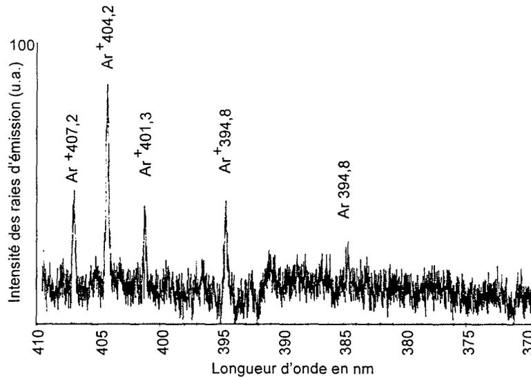
**Figure II.2** : Spectre total d'émission optique réalisé dans l'argon pur ( $I_{\text{Anode circulaire}} = I_{\text{Anode cylindrique}} = 120$  A,  $P_{\text{enceinte}} = 0,4$  Pa,  $T_{\text{résistance}} = 500^{\circ}\text{C}$ ).
