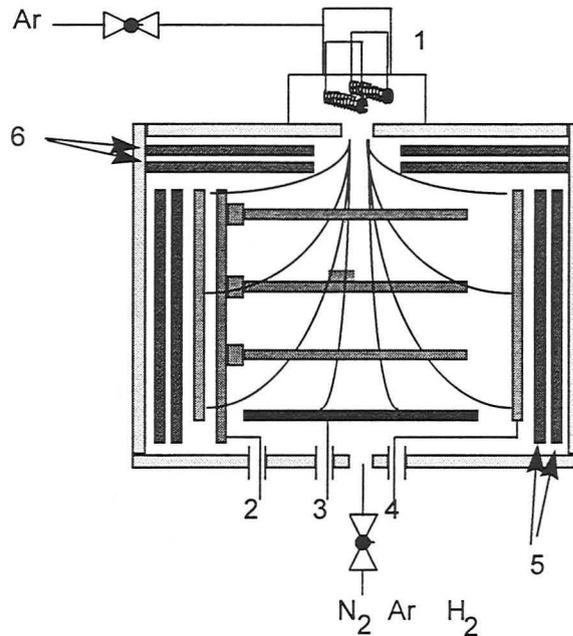
**Figure I.14** : Schéma de principe du prototype BAI730N utilisé pour les traitements de nitruration à basse pression assistée par une décharge d'arc : Chambre d'ionisation (1), porte substrat sur lequel repose 3 grilles (2), anode circulaire située sur la platine inférieure et reposant sur des isolateurs (3), anode cylindrique (4), écrans thermiques cylindriques (5), écrans thermiques circulaires (6).
