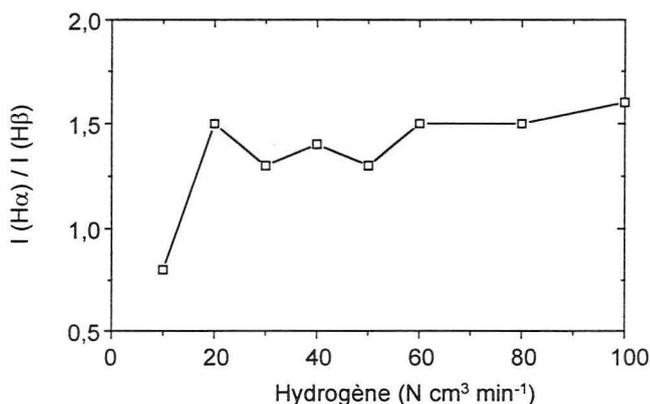
**Figure II.37** : Evolution du rapport des intensités des raies H $\alpha$  sur H $\beta$  en fonction du débit d'hydrogène introduit dans une décharge d'argon (pression d'argon initiale de 0,35 Pa) 120 A sur chaque anode.
