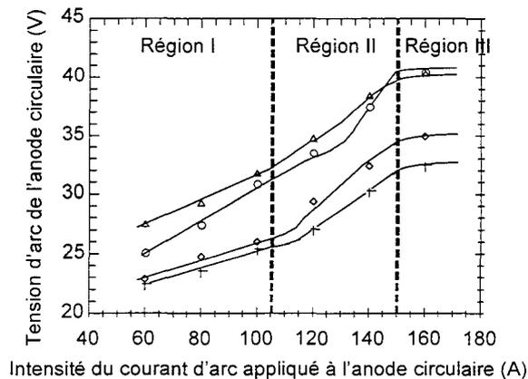
**Figure II.7** : Caractéristiques Courant - Tension de la décharge d'arc à différentes pressions d'argon (Δ) 0,3 Pa, (o) 0,4 Pa, (◇) 0,6 Pa, (+) 0,8 Pa.
