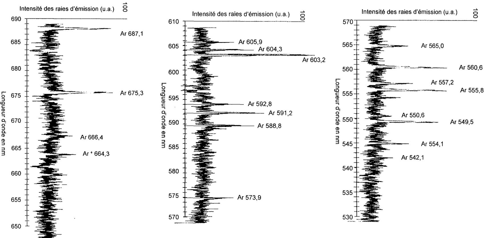
**Figure II.2 :** Spectre total d'émission optique réalisé dans l'argon pur (l'Anode circulaire = l'Anode cylindrique = 120 A, P<sub>enceinte</sub> = 0,4 Pa, T<sub>résistance</sub> = 500°C).
