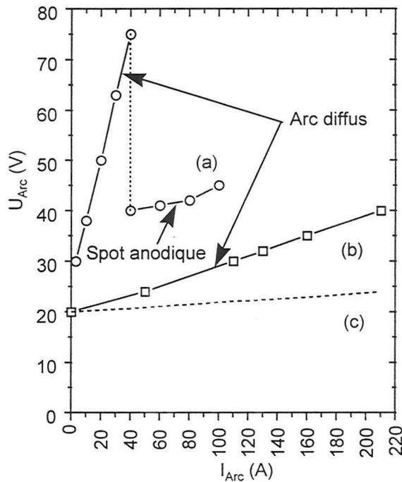
**Figure I.9** : Caractéristiques courant-tension d'un arc avec des électrodes en cuivre dans le vide [I.30]. Pour une distance interélectrode de 5 mm et un diamètre de l'anode égal à 12,5 mm (a) et 50 mm (b). (c) mesure de la chute cathodique.
