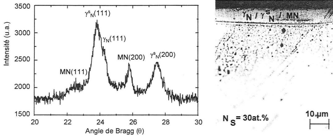
Figure III.4 : (a) Cliché de diffraction des rayons X ( $\lambda$   $K_{\alpha}$  Co = 0,17902 nm, 4°), (b) Coupe métallographique d'un échantillon traité dans les conditions de l'expérience 2 (voir Tableau III.3). La structure est révélée par le réactif Parmitter.
