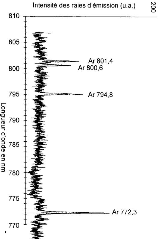
**Figure II.2 :** Spectre total d'émission optique réalisé dans l'argon pur ( $I_{\text{Anode circulaire}} = I_{\text{Anode cylindrique}} = 120$  A,  $P_{\text{enceinte}} = 0,4$  Pa,  $T_{\text{résistance}} = 500^{\circ}\text{C}$ ).
