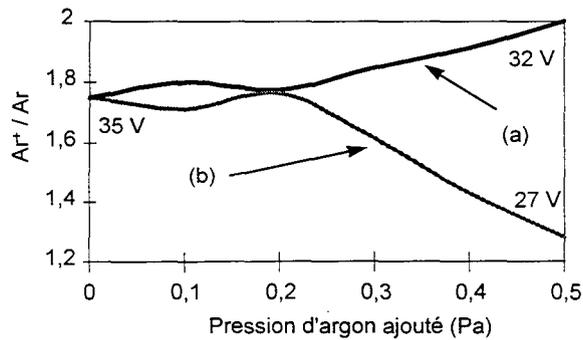
**Figure II.13** : Contribution de la pression partielle d'argon ajoutée au sein du réacteur par la platine inférieure (a) ou directement dans la chambre d'ionisation (b) sur le rapport d'intensité des raies  $Ar^+ / Ar$ . L'intensité du courant d'arc vaut 120 A sur chaque anode et la pression initiale est de 0,32 Pa.
