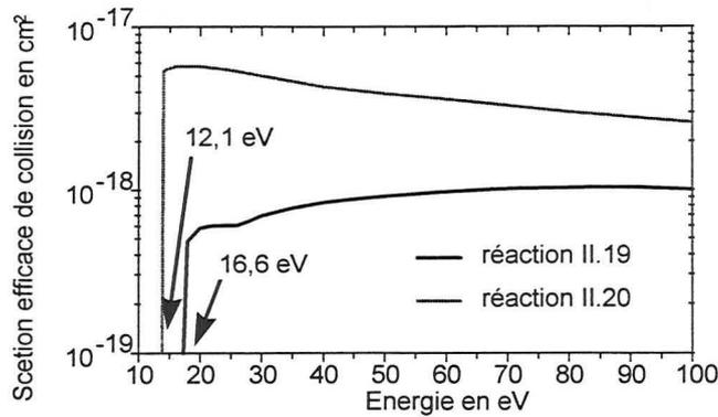
**Figure II.34** : Section efficace d'émission pour la transition correspondant à la raie  $H_{\alpha}$  correspondant au processus d'excitation dissociative **réaction II.19 [II.51-II.52]** et au processus d'excitation directe **réaction II.20 [II.53]**.
