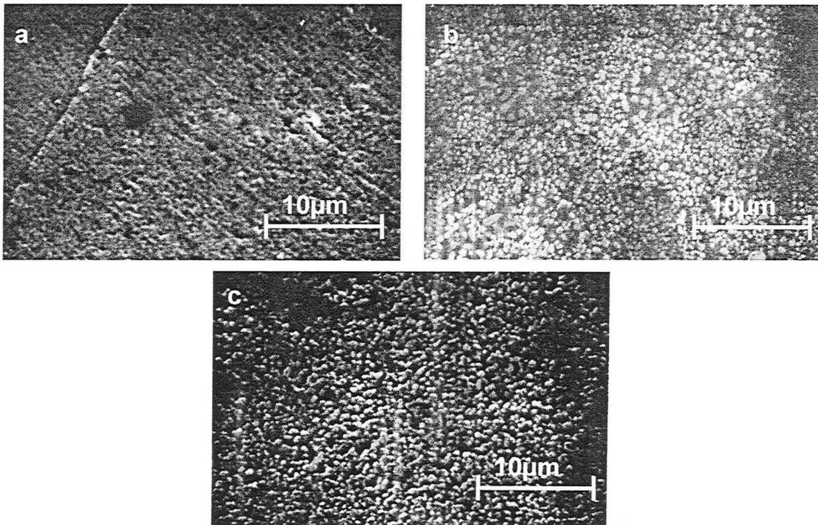
**Figure IV.10** Morphologie de surface observée par microscopie électronique à balayage pour différents traitements de nitruration. (a) Substrat décapé et nitruré au potentiel flottant, (b) Substrat décapé sous -50V et nitruré au potentiel flottant, (c) Substrat décapé sous -80V et nitruré au potentiel flottant.
