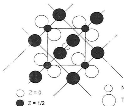
Figure 3 : Structure quadratique type anti-rutile du titane  $\epsilon$ -Ti<sub>2</sub>N. (Tableau 2, Données radiocristallographiques du titane  $\epsilon$ ).
