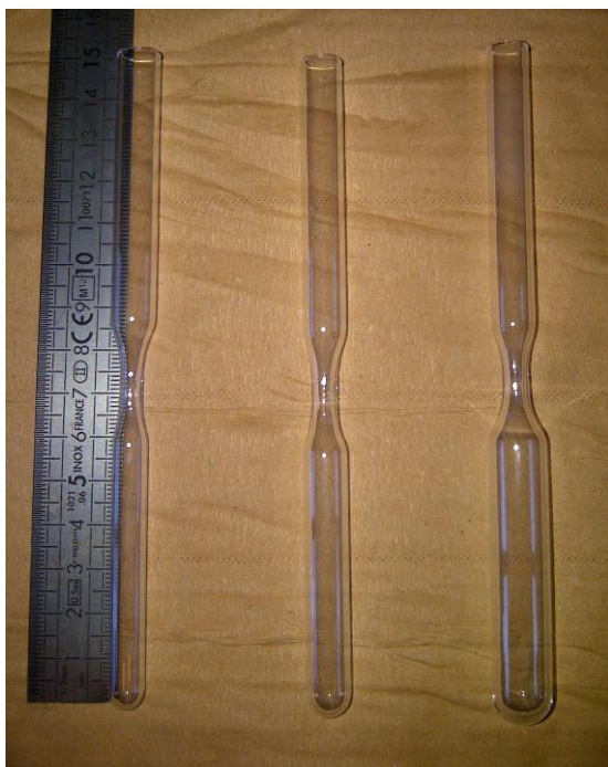
Figure III-1 : A gauche, les différents tubes utilisés (de gauche à droite, le diamètre interne varie de 6 à 11 mm). A droite, le système de rampe à vide utilisé pour le scellage des tubes. La pompe secondaire associée fonctionne à la manière d'un piège froid et doit donc être régulièrement remplie d'azote liquide.
