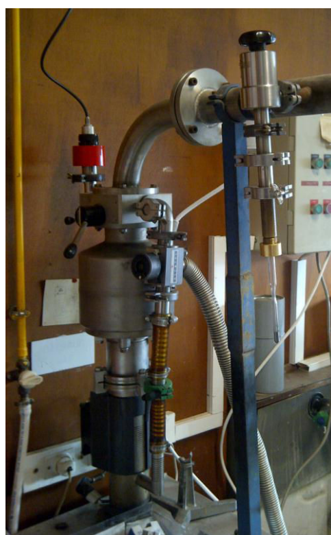
Figure III-1 : A gauche, les différents tubes utilisés (de gauche à droite, le diamètre interne varie de 6 à 11 mm). A droite, le système de rampe à vide utilisé pour le scellage des tubes. La pompe secondaire associée fonctionne à la manière d'un piège froid et doit donc être régulièrement remplie d'azote liquide.
