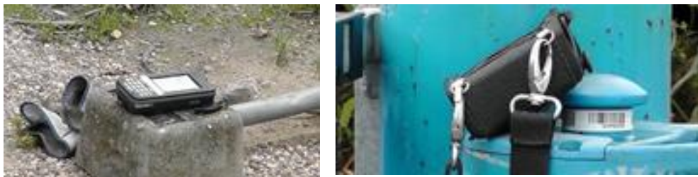
Figure 47. Equipements introduits dans le cadre de la mise en place du système de traçabilité : lecteur de code-barre (handheld) et imprimante.
