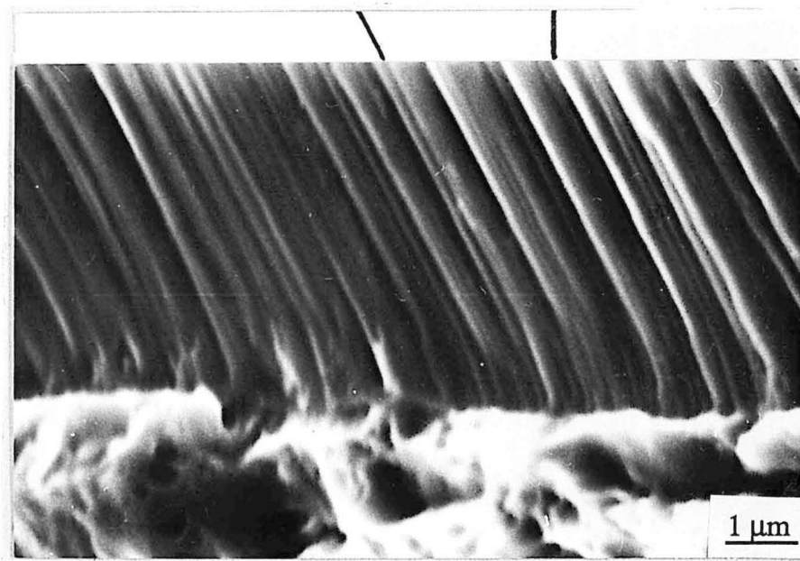
Figure II-20 : Dépôt amorphe (Fe-25Cr-20Ni)_{85}C_{15} élaboré à 0,4 Pa sur un substrat rectifié et excentré par rapport à l'axe de l'émetteur : la direction de croissance des colonnes est sensiblement parallèle au flux de vapeur métallique incident
