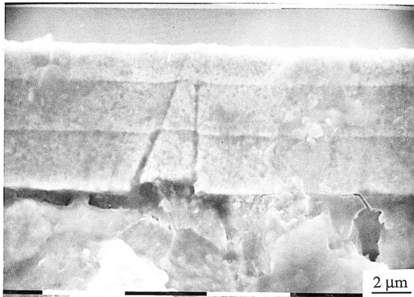
Figure II-25 : Exemple de défaut de croissance "conique inversé" observé dans les revêtements cristallisés (sensibles au réactif de Marble).
