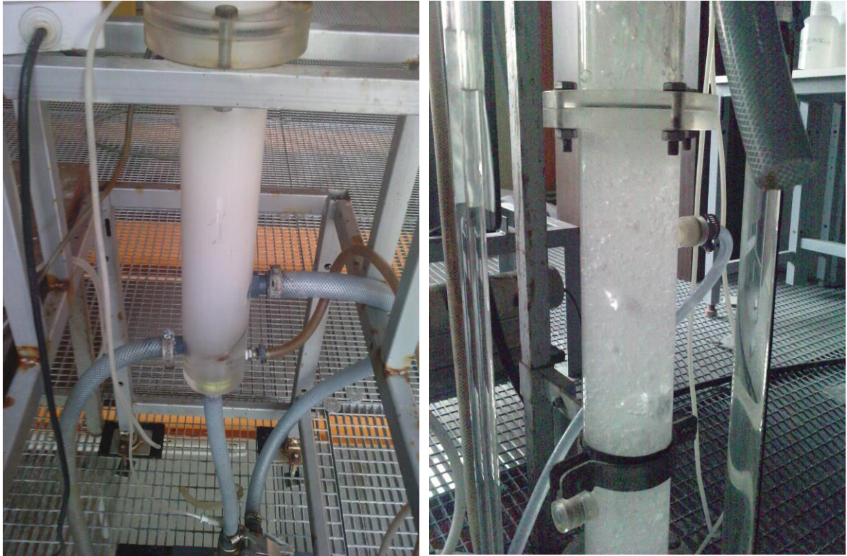
Figure 45 Photographies mettant en évidence les problèmes rencontrés lors de l'utilisation du générateur de bulles Microcel dans la colonne d76
