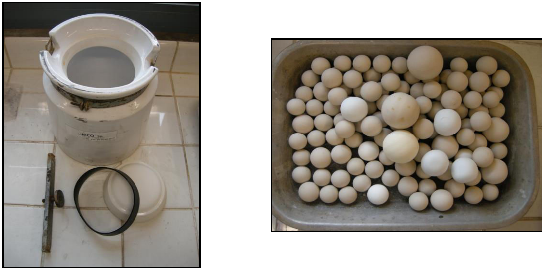
Figure 17 gauche : broyeur en céramique, droite : corps broyants en boulets de céramique
