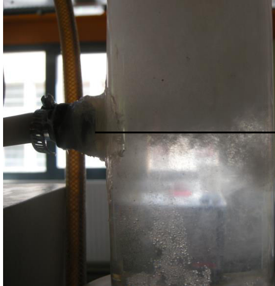
Figure 46 Photographie prouvant la résolution du problème par l'utilisation du générateur de bulles Flotaire dans la colonne d76
