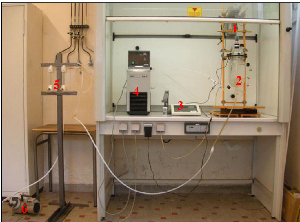
Figure 19 Appareillage de la carbonatation en réacteur agité thermostaté (1 : moteur, 2 : réacteur agité, 3 : pH-mètre, 4 : thermostat, 5 : débitmètres, 6 : pompe à air)
