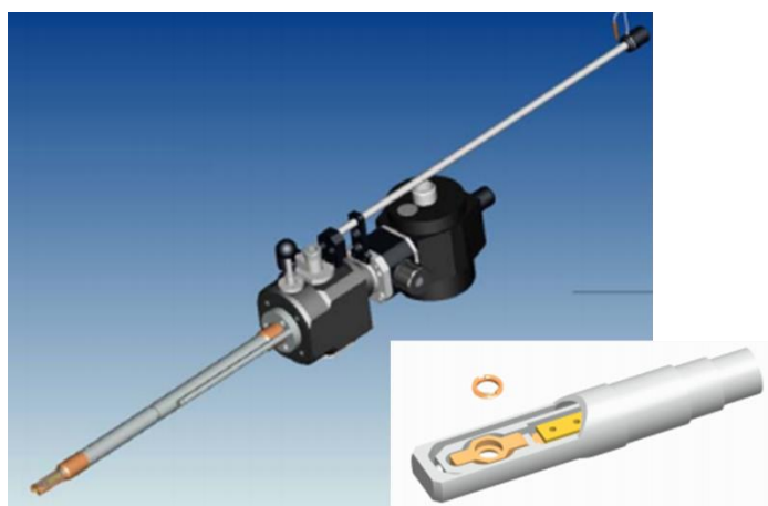
Figure 72 : Image du porte-échantillon étanche.
