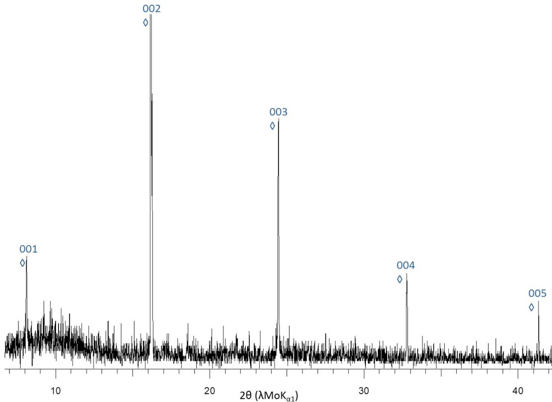
**Figure 17 : Diffractogramme des réflexions  $00l$  du composé  $\alpha$ , préparé par immersion d'une plaquette de pyrographite dans un alliage Au-K contenant 50% atomique d'or à 650°C pendant 2 jours.**
