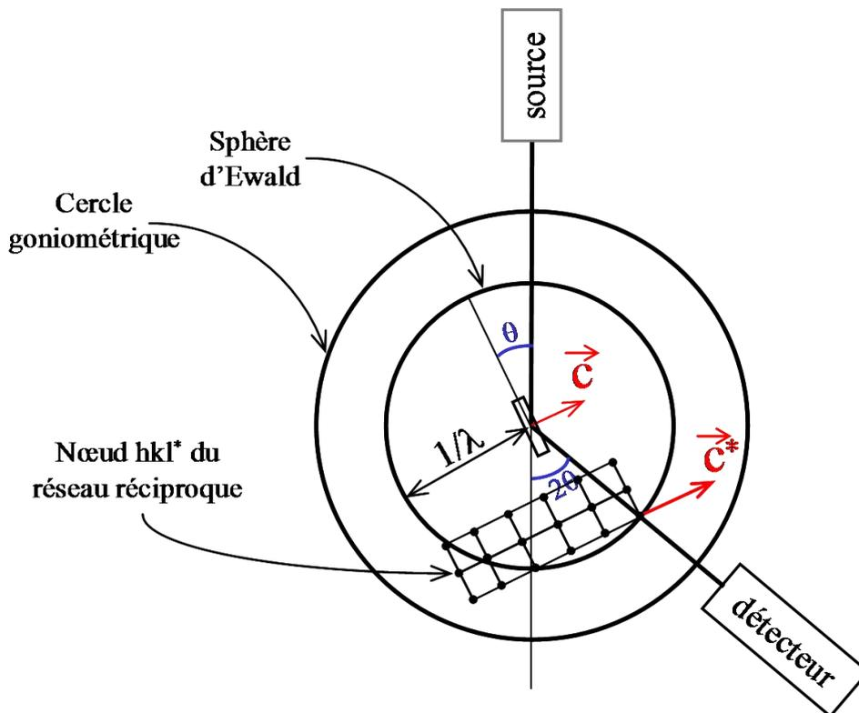
Figure 112: Dispositif employé pour enregistrer le diffractogramme  $00l$ .
