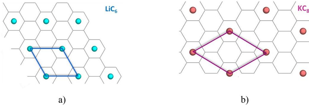
Figure 65 : Représentation de la maille plane de a)  $\text{LiC}_6$  et b)  $\text{KC}_8$ .
