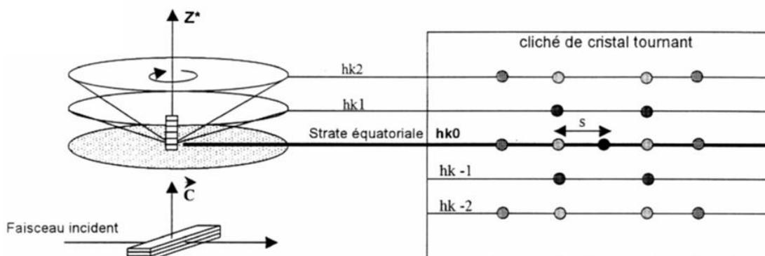
Figure 114: Représentation de la méthode du cristal tournant.
