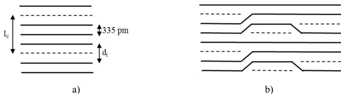
**Figure 4 : Représentation schématique de l'empilement selon  $\vec{c}$  d'un composé d'intercalation de stade 3**
