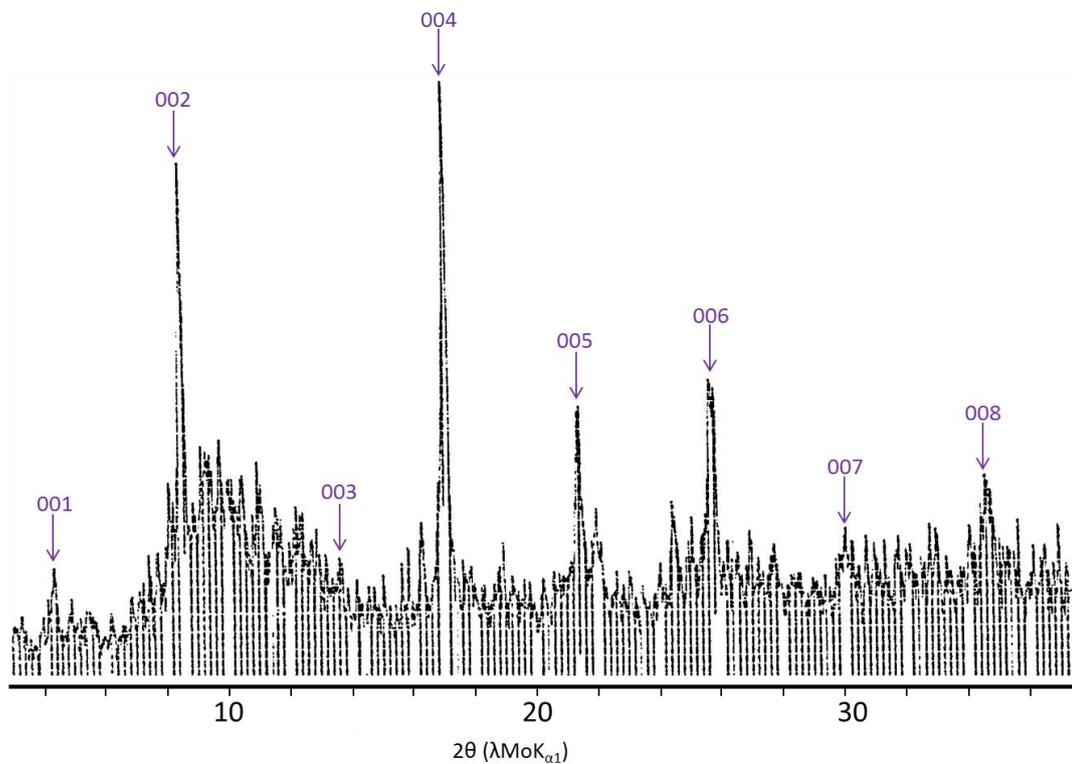
Figure 75 : Diffractogramme  $00l$  du composé  $\beta$ .
