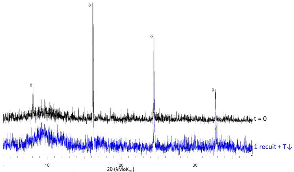
**Figure 19 : Diffractogrammes des réflexions 00*l* du composé  $\alpha$ ,**
