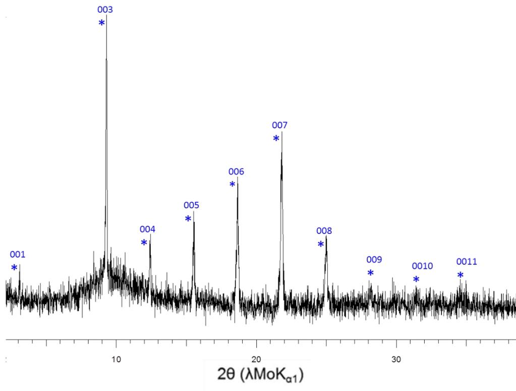
Figure 13 : Diffractogramme des réflexions 00 $l$  du composé  $\gamma$ , préparé par immersion d'une plaquette de pyrographite dans un alliage Au-K contenant 34% atomique d'or à 440°C pendant 8 jours.
