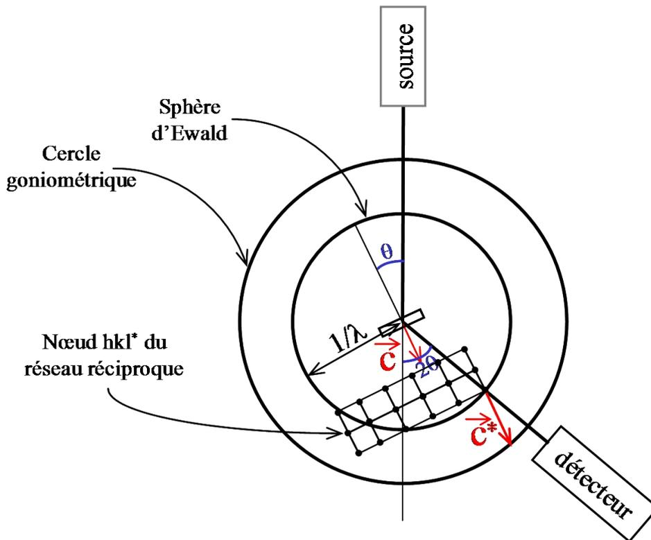
Figure 113: Dispositif permettant d'enregistrer les réflexions  $hk0$ .
