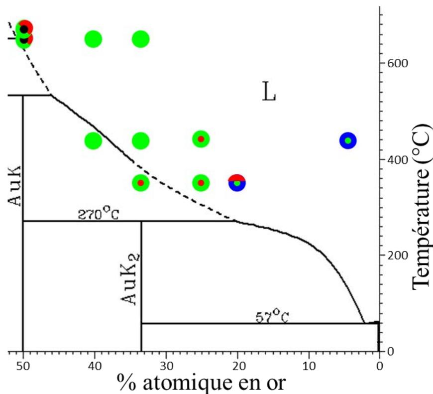
Figure 20 : Conditions de synthèse des différentes phases observées dans le système graphite-potassium-or (● KC<sub>8</sub>, ● phase  $\alpha$ , ● phase  $\beta$ , ● phase  $\gamma$ ) pour des réactions menées pendant 2 à 14 jours.
