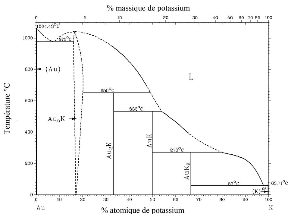
Figure 11 : Diagramme de phases Au-K [83].
