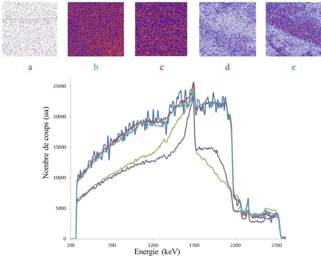
**Figure 110 : Cartes représentant la somme des distributions élémentaires des éléments constituant l'échantillon et spectres associés.**
