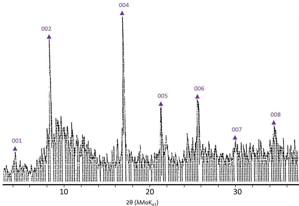
**Figure 15 : Diffractogramme des réflexions  $00l$  du composé  $\beta$ , préparé par immersion d'une plaquette de pyrographite dans un alliage Au-K contenant 50% atomique d'or à 650°C pendant 3,5 jours.**
