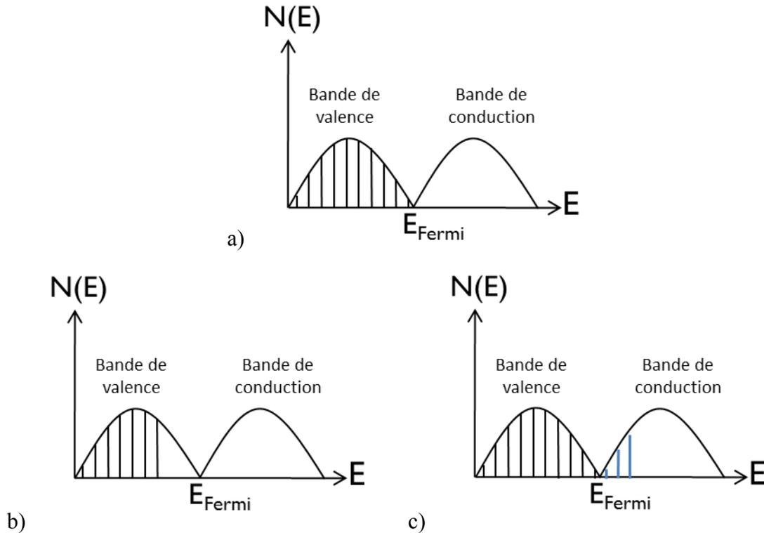
**Figure 3 : Représentation du transfert électronique lors du phénomène d’intercalation dans le graphite**
