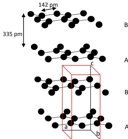
**Figure 1 : Représentation de la structure hexagonale du graphite.
