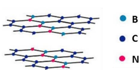
Figure 91 : Représentation schématique du composé graphitique B-C-N.
