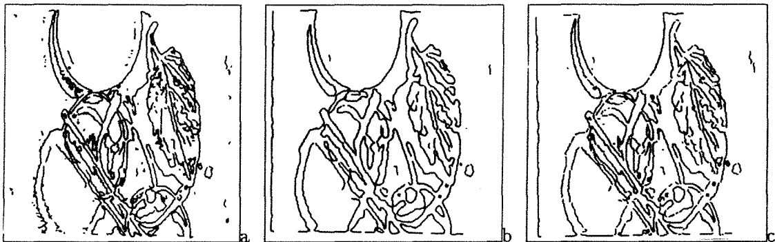
Figure 1.3. a) et b) deux images de contours obtenues par le détecteur DL (cf. 2.4) à deux échelles différentes ( \alpha = 0.75 et \alpha = 1.2 ), c) résultat de la fusion de ces deux images.
