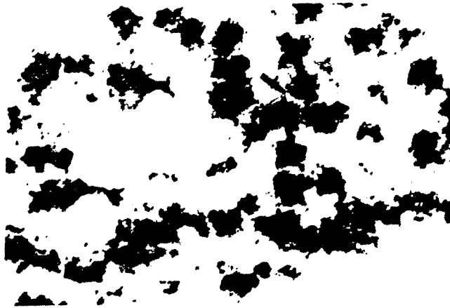
Figure V-4 : Topographie monochromatique réalisée par réflexion (113) sur une section (100) d'un échantillon ayant subi un traitement thermique d'homogénéisation des microségrégations [4].
