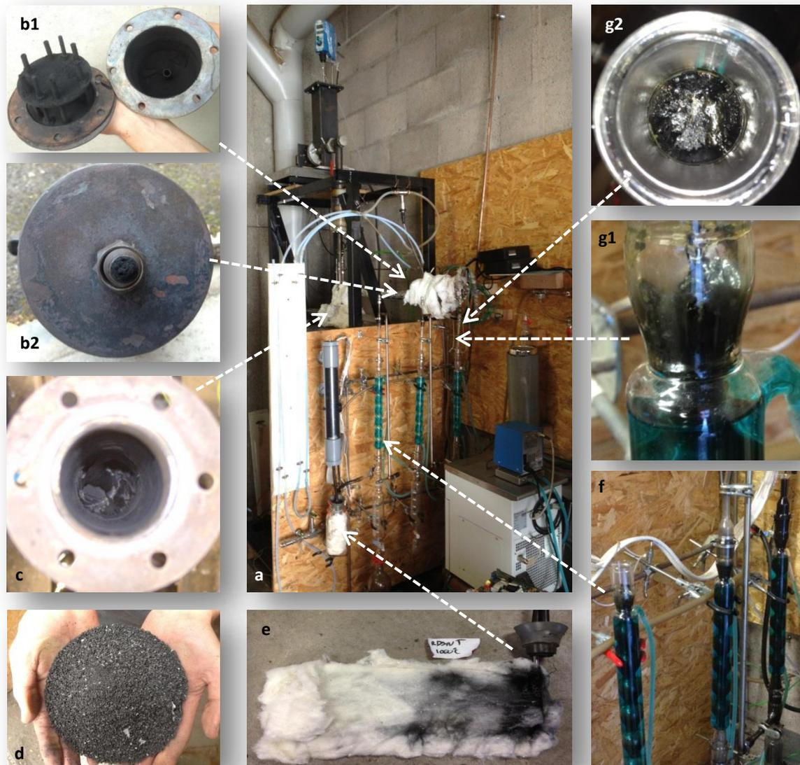
**a** : installation ; **b** : filtre à particules **1** : intérieur, **2** : entrée ; **c** : feuilles dans le réacteur ; **d** : charbon + feuilles ; **e** : filtre coton ; **f** : condenseurs ; **g** : tête de condenseur **1** : profil, **2** : dessus.
