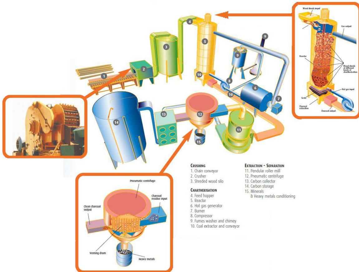
**Figure 18 :** Schéma de principe du procédé Chartherm.
