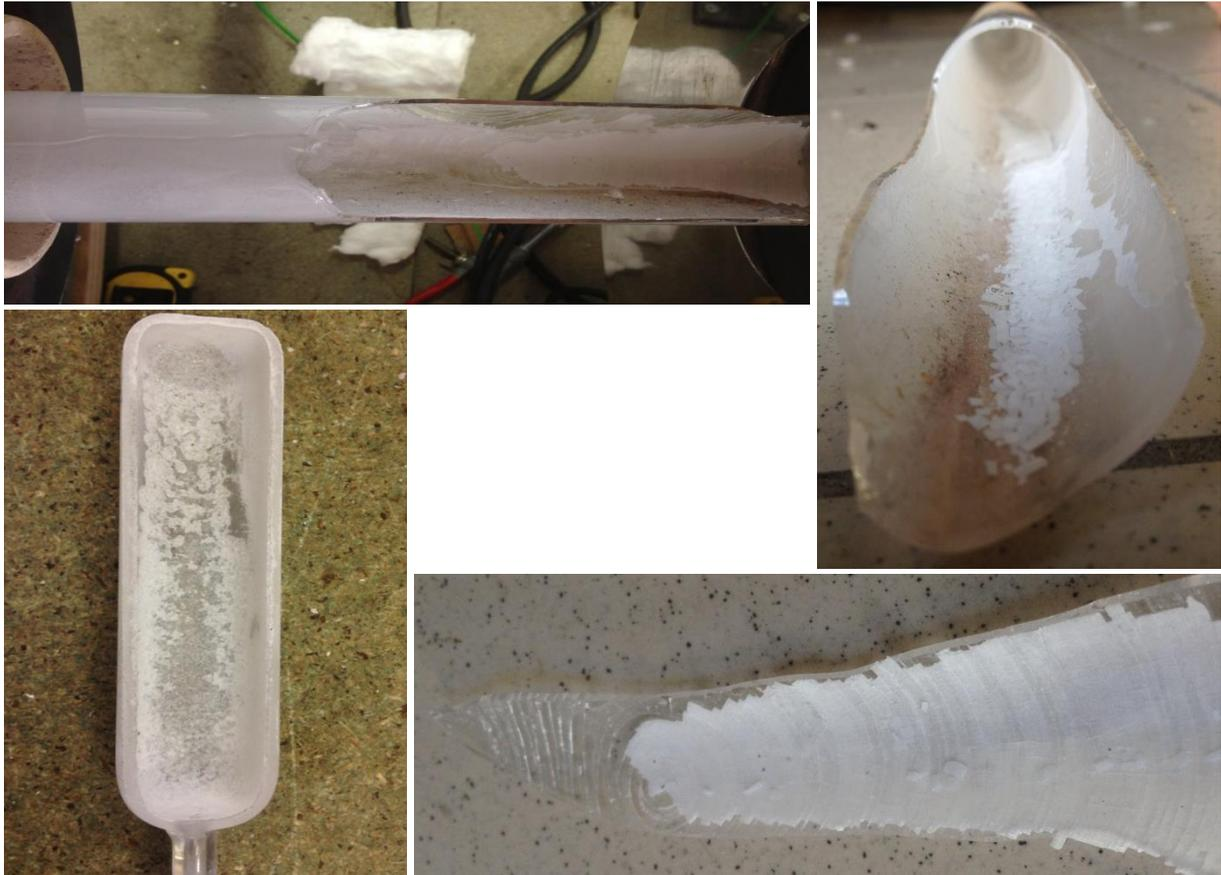
**Figure 204** : Vues du réacteur et de la nacelle après plusieurs activations de charbons actifs issus de RDS à 1000°C.
