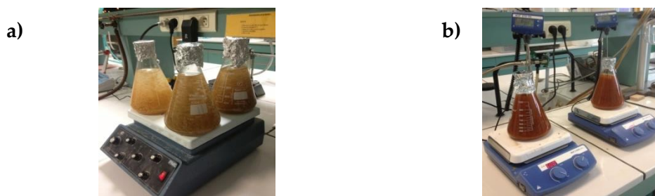
Figure 95 : Lavage des échantillons de RDS à l'eau (a) et à l'acide nitrique (b).
