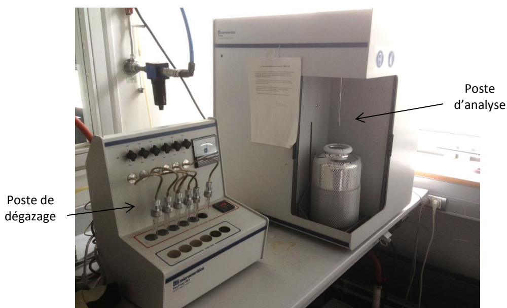
Figure 199 : Photo du Micromeritics Tristar utilisé pour la détermination des surfaces BET.
