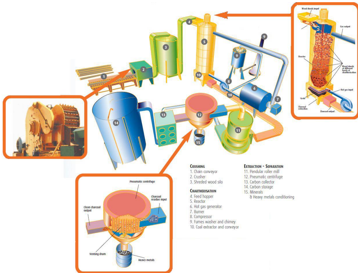
Figure 18 : Schéma de principe du procédé Chartherm.
