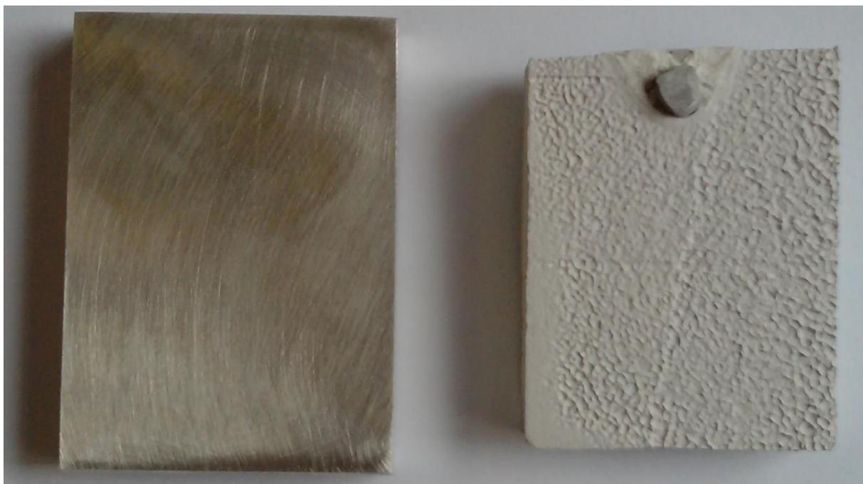
**Figure V-12 : Photographie d'un échantillon avant traitement (gauche) et d'un échantillon après un traitement de 40 minutes dans un électrolyte composé de 10 g.L<sup>-1</sup> de NH<sub>4</sub>F (droite).**
