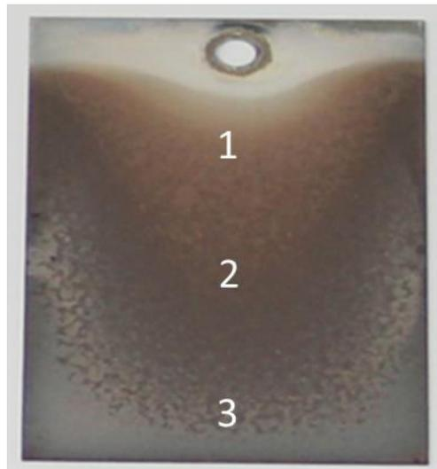
Figure IV-4 : Echantillon après traitement. Les zones 1, 2 et 3 correspondent respectivement à des zones pré-autorégulation, en cours de passage en autorégulation et post-autorégulation.
