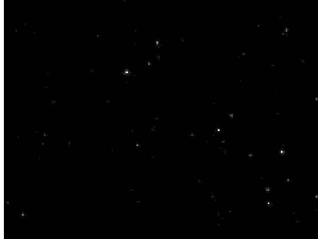
Figure V-46 : Acquisition par imagerie rapide durant la demi-période cathodique à 3 minutes de traitement mené sur un substrat de magnésium dans un électrolyte \text{NH}_4\text{F} ( 10 \text{ g.L}^{-1} ) + \text{Na}_6\text{P}_6\text{O}_{18} ( 5 \text{ g.L}^{-1} )
