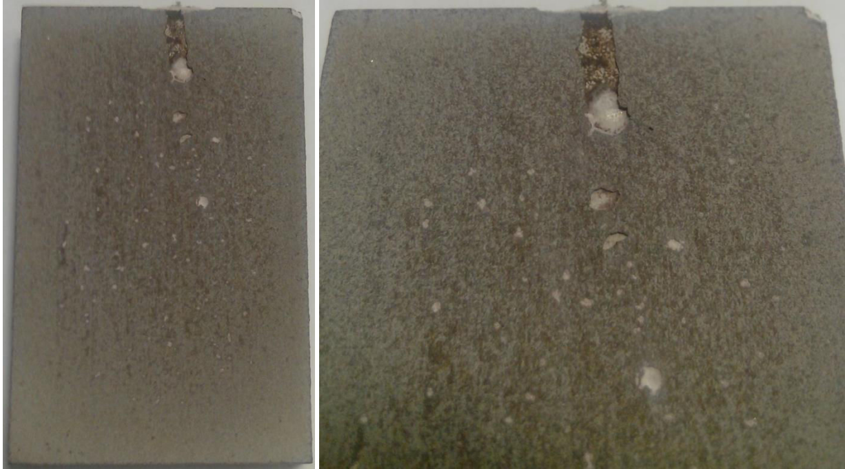
Figure V-21 : Photographies d'un échantillon d'aluminium prétraité (45 \mu\text{m} ), après traitement dans un électrolyte \text{NH}_4\text{F} (10 \text{g.L}^{-1} ).
