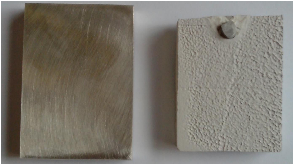
Figure V-12 : Photographie d'un échantillon avant traitement (gauche) et d'un échantillon après un traitement de 40 minutes dans un électrolyte composé de 10 g.L -1 de NH 4 F (droite).
