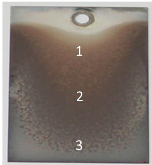
Figure IV-4 : Echantillon après traitement. Les zones 1, 2 et 3 correspondent respectivement à des zones pré-autorégulation, en cours de passage en autorégulation et post-autorégulation.
