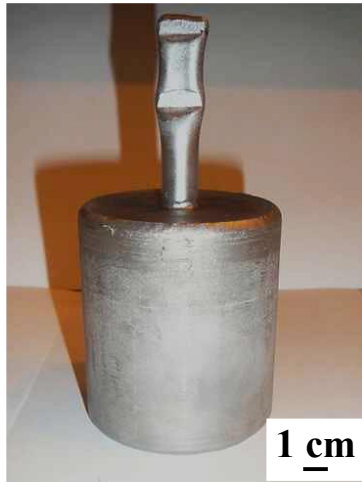
Figure II-4 : Matrice en acier bas carbone scellée sous vide secondaire contenant la poudre Nb-Nb 5 Si 3 avant l'étape de HIPping
