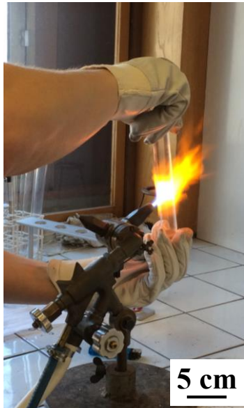
Figure II-7 : Fabrication du réacteur par travail de la silice à chaud : étape permettant de réaliser l'étranglement.
