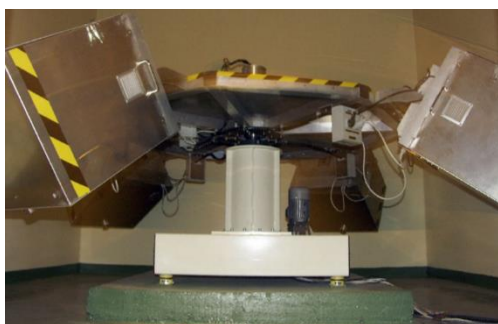
Figure 30 : Photographie de la centrifugeuse à grand rayon utilisée pour réaliser les expérimentations à 2G.
