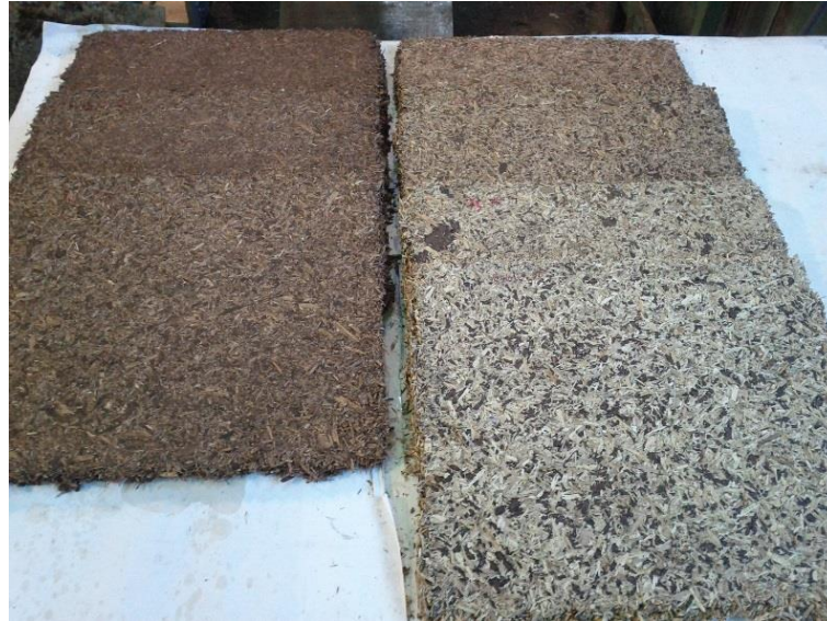
Figure 37. Photo de panneaux de particules réalisés en laboratoire avant ponçage.
