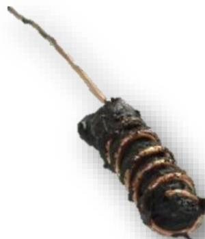
Figure 35. Photo d'un agitateur métallique sorti du tube après formation du gel.
