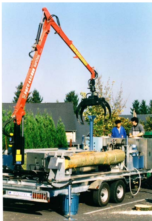
Figure 31 : Photographie du premier prototype préindustriel d'imprégnation axiale (1996)
