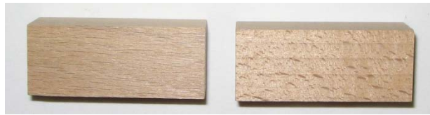
Figure 121 : Photographie du bois de hêtre non traité ; face tangentielle (à gauche) et face radiale (à droite)
