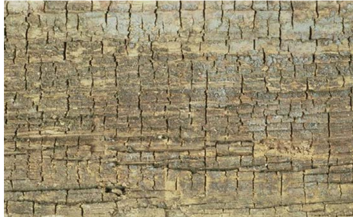
Figure 19 : Aspects du bois dégradé par la pourriture molle
