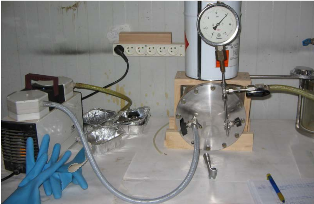
Figure 68 : Photographie du dispositif utilisé pour l'imprégnation vide-pression en fonctionnement : la cuve est au centre, le manomètre est fixée dessus ; la pompe à vide est à gauche, et la pression vient du réseau d'air comprimé
