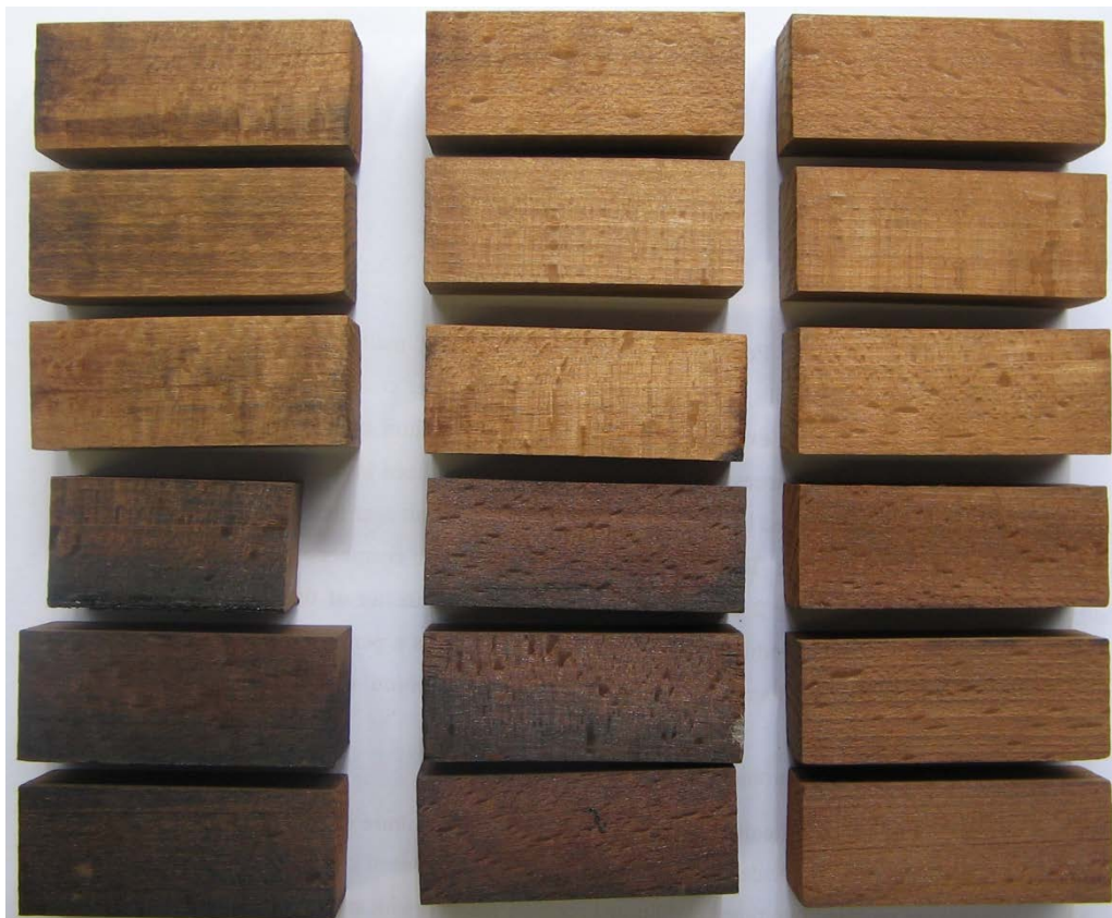
Figure 150 : Photographies des échantillons de composites issus des traitements sous vide / pression ; les trois colonnes représentent les trois concentrations testées : 50% à gauche, 25% au milieu et 12% à droite ; les neuf échantillons du haut n'ont pas été confinés, tandis que les neuf échantillons du bas ont été emballés dans l'aluminium pour le chauffage
