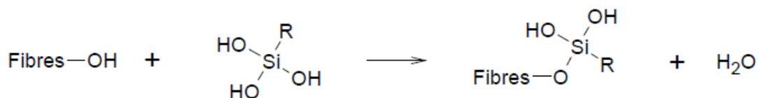
Figure 44 : Silanisation : réaction de silanols sur les groupements hydroxyles de la cellulose (98)
