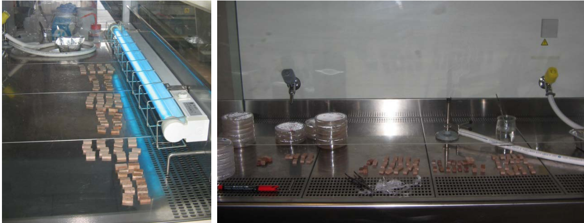
Figure 75 : Photographies de microbiologie : stérilisation UV dans une enceinte stérile des échantillons de composites préalablement aux tests microbiologiques (à gauche) / mise en place des échantillons stérilisés dans les boîtes de Pétri colonisés par le mycélium des champignons lignivores (à droite)
