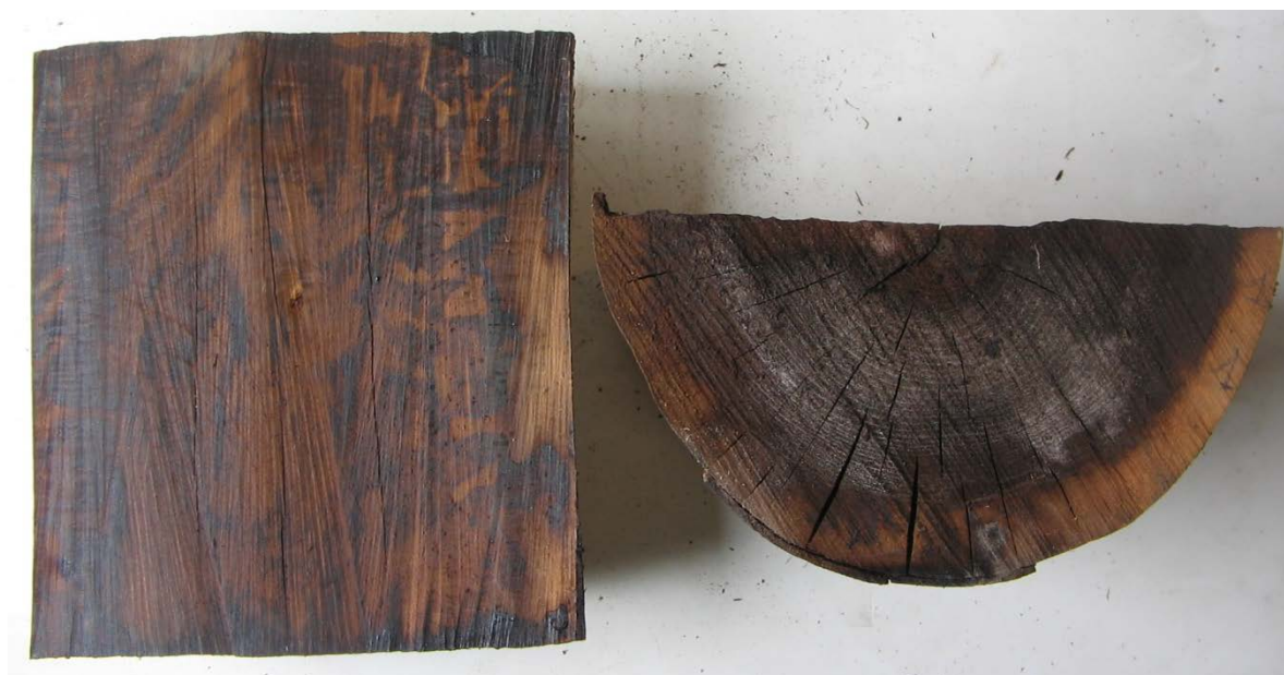
Figure 160 : Photographie du billon brut après le traitement avec une solution d'alcool furfurylique à 33%
