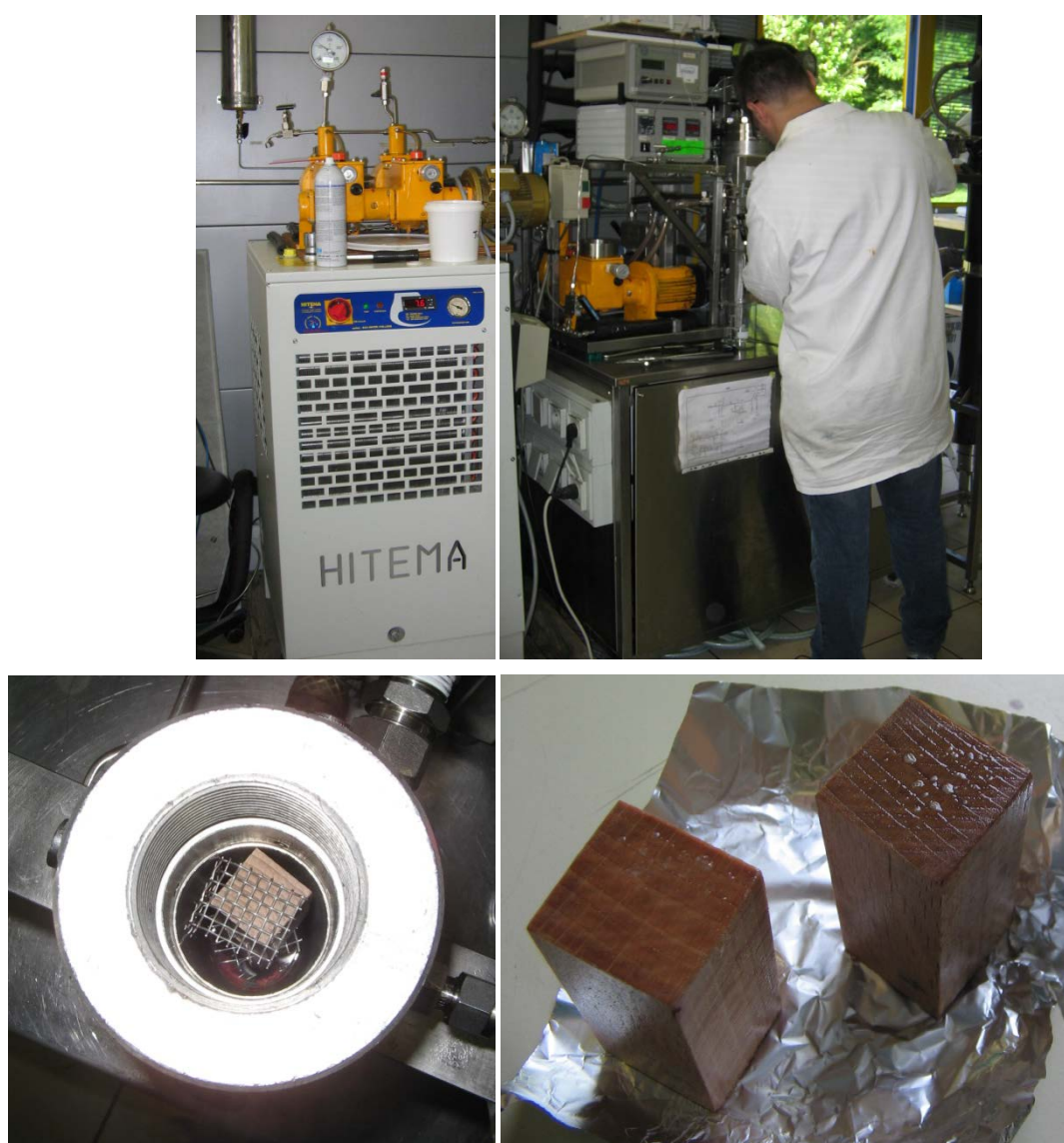
Figure 73 : Planche de photographies réalisées à l'entreprise Séparex : système complet en préparation ; réacteur ouvert avec vue sur l'éprouvette de bois à traiter ; cubes imprégnés présentant un dégagement gazeux à l'issue du traitement
