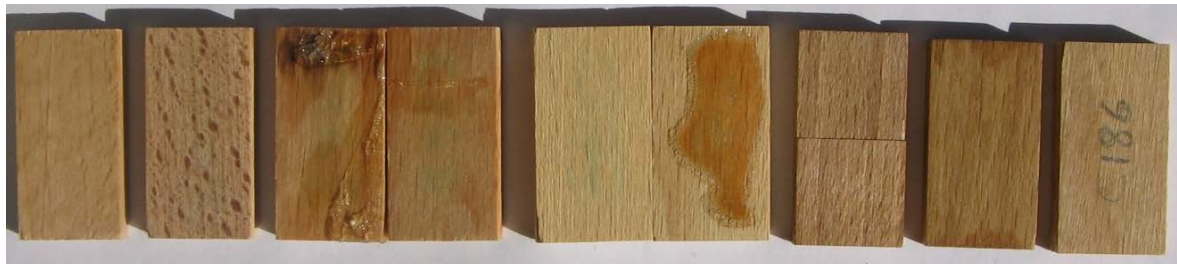
Figure 123 : Photographie des composites préparés à partir d'anhydride méthacrylique – de gauche à droite : sans initiateur, 0,5% de PB, 2% de PB, dilué dans le méthanol ou dans le white-spirit, avec 1% de TEA et enfin avec 1% de TEA et 2% de PB
