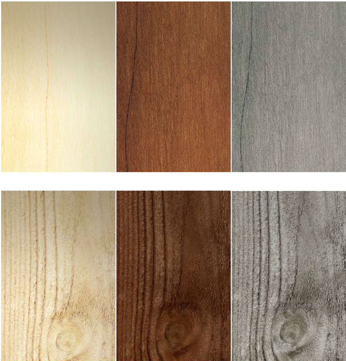
Figure 51 : Aspect de Kebony produit à partir d'érable (en haut) ou de pin sylvestre (en bas) ; de gauche à droite : bois non traité, Kebony et Kebony vieilli patiné (141)
