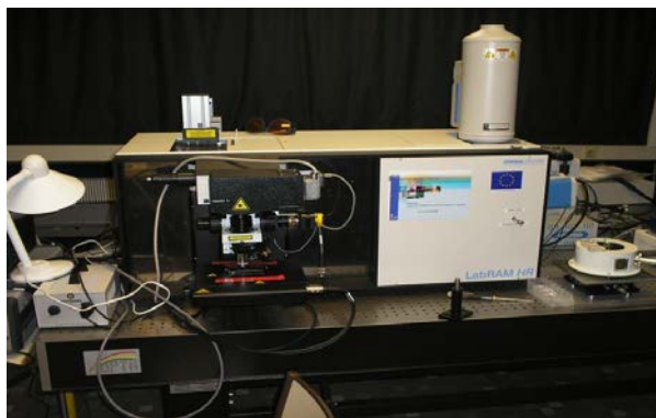
Figure 2-12 Photographie du spectromètre Raman (à gauche) et schéma de principe (à droite).
