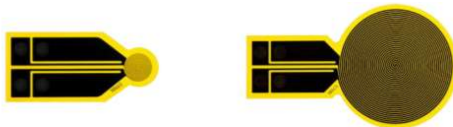
Fig. II-37 – Types de sondes Hot Disk avec isolation Kapton
