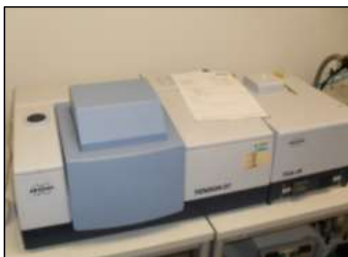
Fig. II-24 – Spectroscopie FTIR Bruker Optics Tensor 27 (à g.) & principe de la FTIR (à d.)
