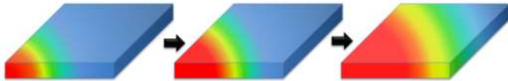
Fig. I-13 – Diffusion de chaleur dans un matériau solide et homogène
