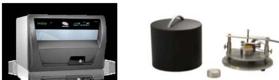
Fig. II-35 – Instrument Hot Disk TPS 2500 S ; Unité TPS 2500 S (à g.) et porte-échantillon (à d.)
