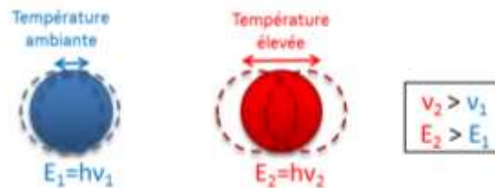
Fig. I-7 – Vibrations internes des particules en fonction de leur température
