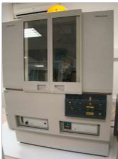
Fig. II-23 – Equipement de DRX Panalytical X'PERT PRO MPD (à g.) et configuration Bragg-Brentano (à d.)
