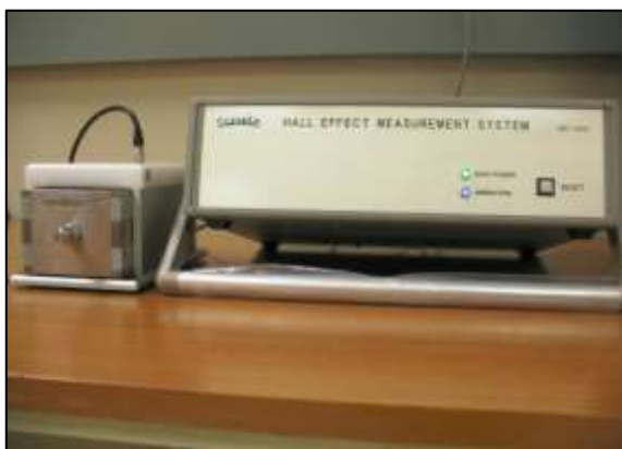
Fig. II-30 – Hall Effect Measurement System HMS 3000 (à g.) et porte-échantillon (à d.)
