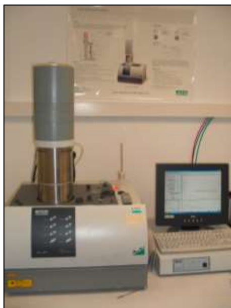
Fig. II-32 – Laser Flash Netzsch LFA 457 Microflash® (à g.) et principe de fonctionnement (à d.)
