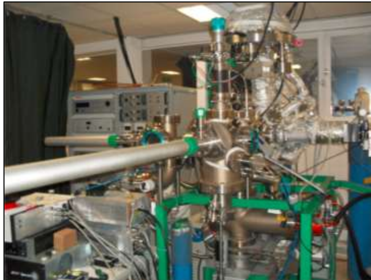
Fig. II-22 – Spectroscopie XPS avec Analyseur hémisphérique d'énergie SPECS (PHOIBOS 150)
