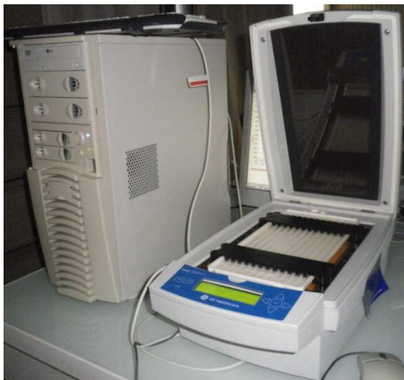
Figure 28: Vue de l'IPGphor3 (GE Healthcare) permettant de réaliser l'iso-électrofocalisation des protéines.
