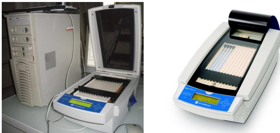
Figure 28: Vue de l'IPGphor3 (GE Healthcare) permettant de réaliser l'iso-électrofocalisation des protéines.
