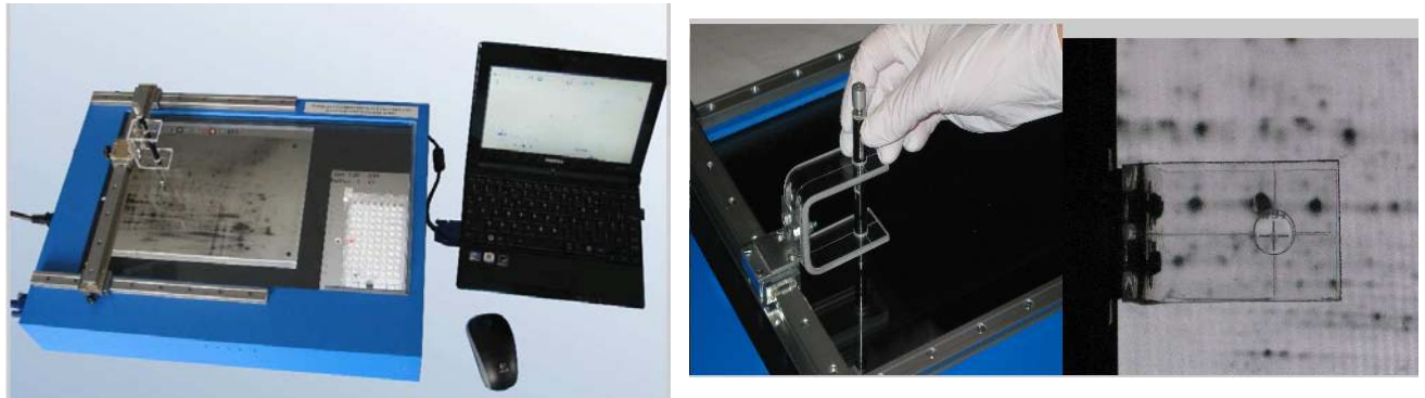
Figure 33 : Vue du Screen Picker (Biosciences, Johnstown PA) utilisé pour le piquage des protéines à identifier.
