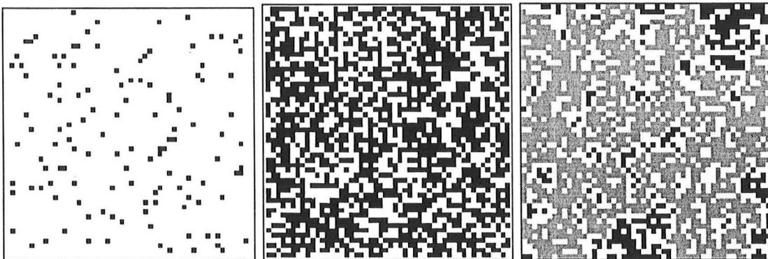
figure 1-1 : images (50 x 50 pixels) générées selon un processus poissonien, chargées à 5 %, 58 % et 62 %. En gris figure l'objet percolant.
