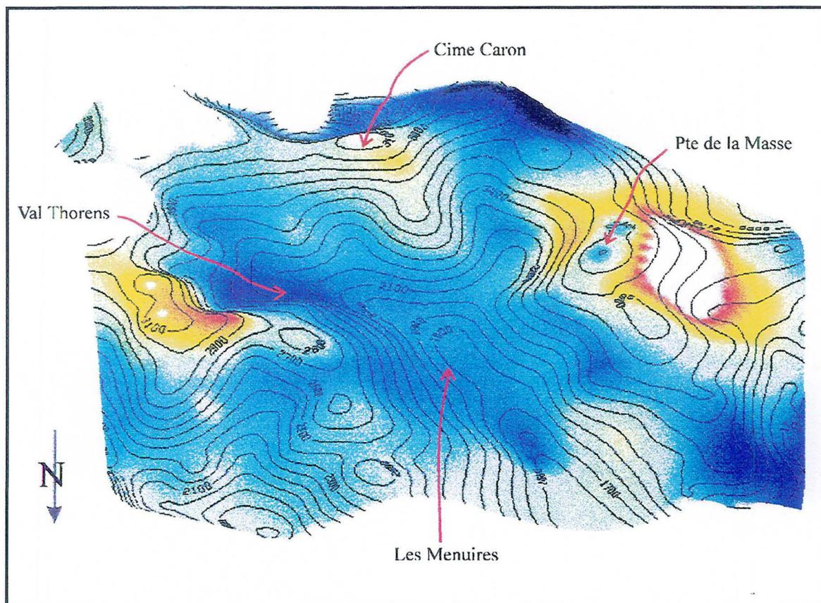
Fig. III-15: Interpolation du paramètre K de Flinn et visualisation du champ résultant sur la surface topographique. La surface est vue depuis le Nord. L'échelle des couleurs est la même que pour le Fig. III-14.
