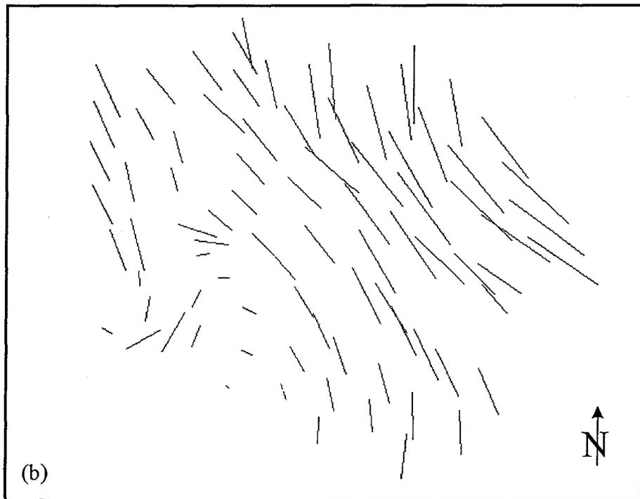
Fig. IV-16: Champ des translations appliquées pour la restauration des plans d'altitude (a) 2500m et (b) 2700m après inversion de la déformation interne par aplatissage.
