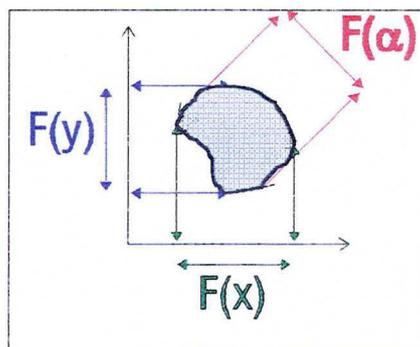
Fig. II-8: Exemple de diamètres de Féret pour les directions  $x$ ,  $y$  et  $\alpha$  dans le cas d'un seul marqueur.
