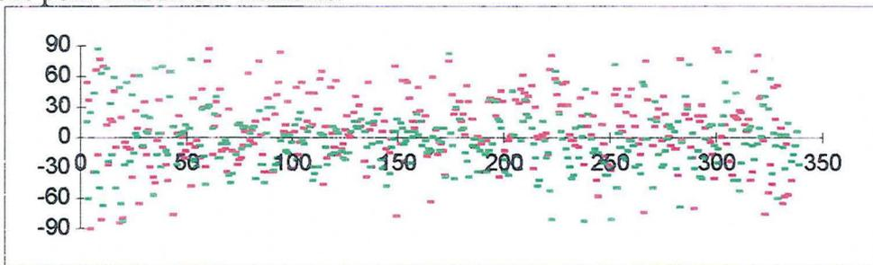
Fig. IV-12: Valeur angulaire de la rotation appliquée pour la restauration des plans d'altitude 2500m (en rouge) et 2700m (en vert) après inversion de la déformation interne par aplatissage pour chacun des éléments.
