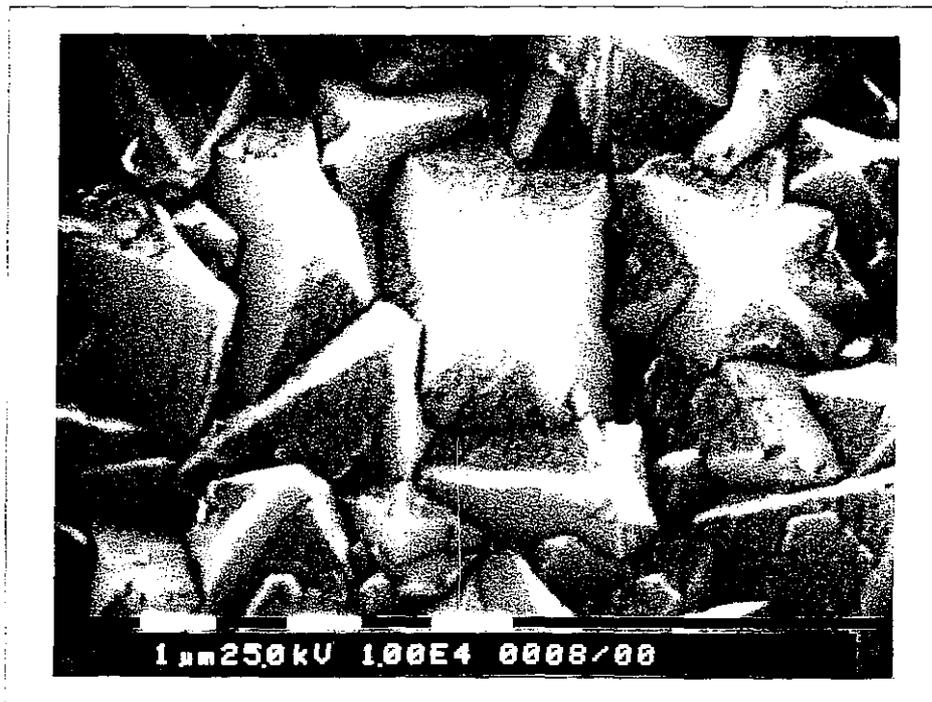
*Figure V.2* : Micrographie MEB - Film texturé  $\langle 110 \rangle$  utilisé pour la préparation de particules minces avec ou sans défauts plans par microclivage
