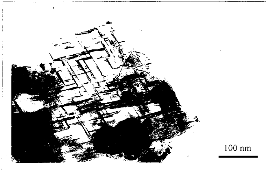
Figure II.1 : Particule mince préparée par microclivage (image en fond clair)
