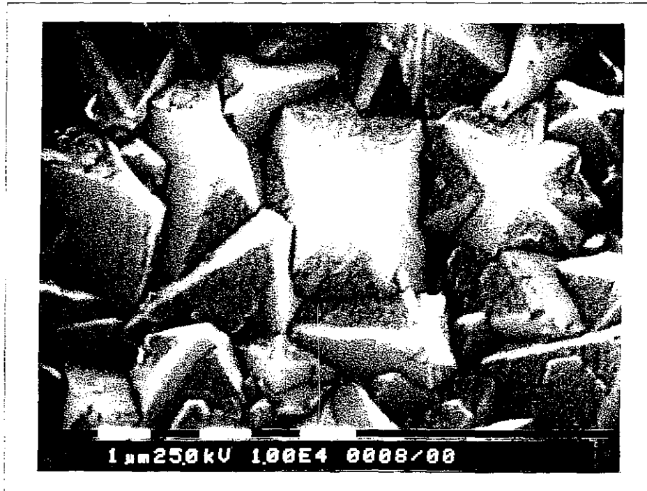
Figure V.2 : Micrographie MEB - Film texturé <110> utilisé pour la préparation de particules minces avec ou sans défauts plans par microclivage Les défauts plans se forment au cours de la croissance suivant les faces {111} (rugueuses). Les volumes cristallins issus de la croissance suivant {100} (faces lisses) ne comportent pas de défauts plans.
