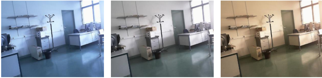
FIGURE 3.3 – Effet de la balance des blancs sur une même scène. Dans ce cas particulier, la scène présente une couleur dominante qui tend vers le bleu lorsque la balance des blanc est réglée à des valeurs faibles (figure de gauche). La figure du milieu présente la même scène lorsque la balance des blancs est réglée à une valeur moyenne, rendant ainsi une capture dont les tons se rapprochent de ce que nous percevons naturellement. La figure de droite présente la scène lorsque le paramètre est réglé à une valeur plus importante, laissant apparaître une couleur dominante qui tend vers l’orange.
