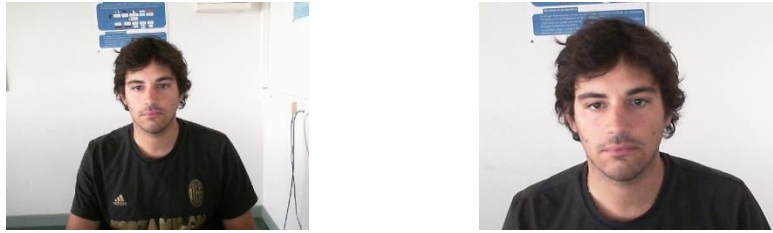
FIGURE 3.13 – Contrôle du zoom, du panoramique et de l’inclinaison. Le visage remplit progressivement la trame délivrée par la caméra à mesure que le zoom augmente. La capture de gauche est un enregistrement de la trame initiale tandis que la capture de droite correspond à un enregistrement après 10 itérations.
