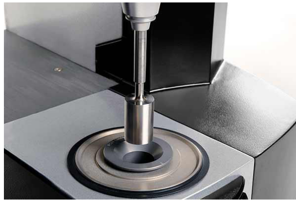
Figure 4. Rhéomètre à cylindres coaxiaux (Kinexus ultra plus Malvern).
