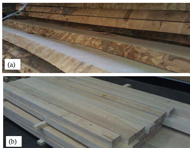
Figure 3.1 – Plots et avivés de hêtre
