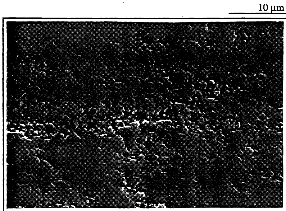
Figure V-28 : Morphologie du revêtement de zircon réalisé à 480 °C sur un tube de gainage en Zircaloy-4 (M.E.B.), après passage de l'indenteur ( F = 10 \text{ N} ).
