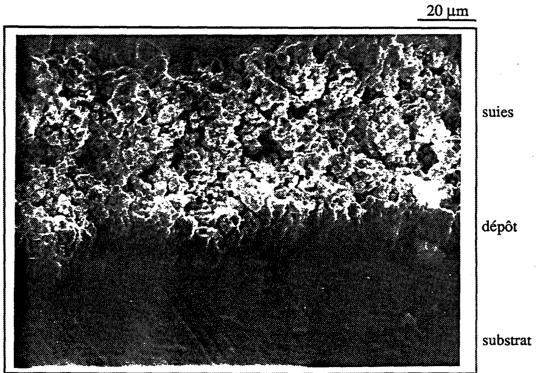
Figure IV-16 : Morphologie du dépôt CVD de zircone (section transversale) synthétisé à 300 °C par hydrolyse de \text{ZrCl}_4 (M.E.B.). (côte z = 3 cm).
