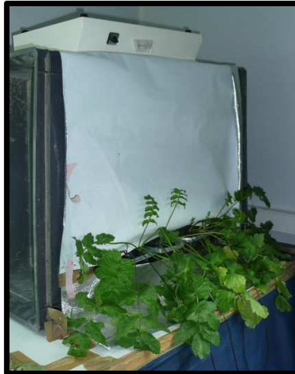
Photographie 2 : Dispositif d'induction des plants de P. sativa aux UVB.
