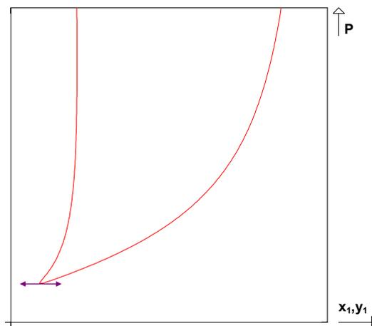
**Figure I-18 :** Diagramme de type III présentant un point critique à une température légèrement supérieure à celle du point critique du corps pur (2). La forme des courbes et la position du point critique sont des traces du détachement des courbes de bulle et de rosée de la droite d'abscisse  $x_1, y_1=0$ .
