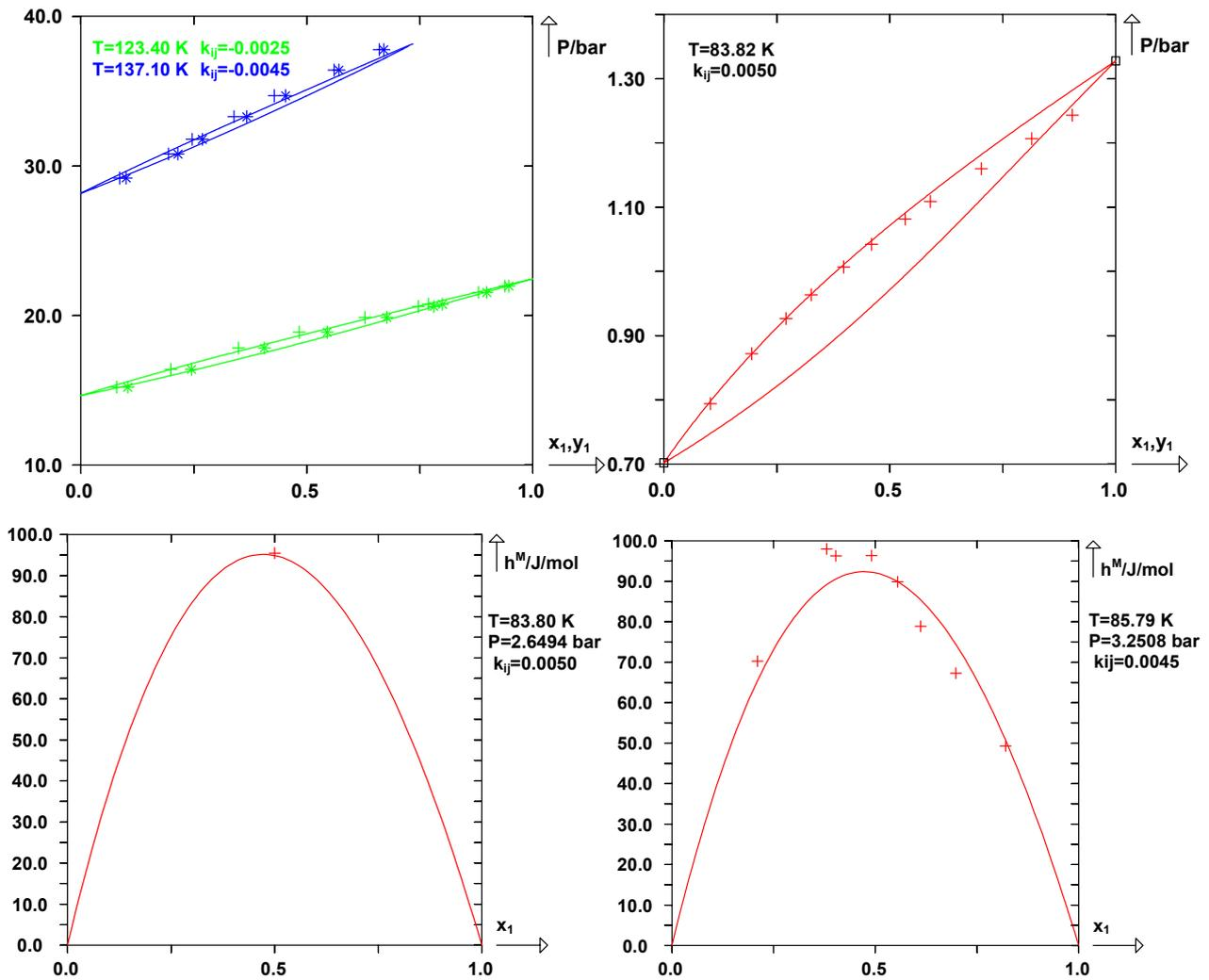
**Figure III-19 :** Diagrammes de phase prédits par le modèle E-PPR78 pour le système CO(1)+Ar(2).
