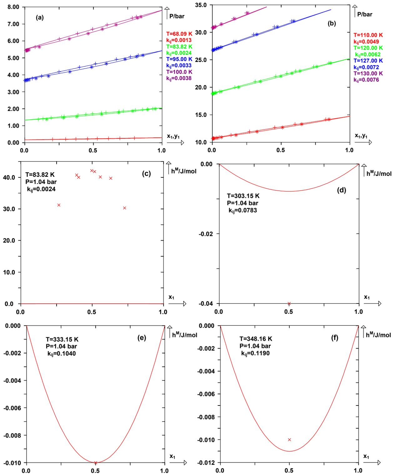
**Figure III-18 :** Diagrammes de phase prédits avec le modèle E-PPR78 pour le système  $N_2(1)+CO(2)$ . (a),(b) : Diagrammes de phase à différentes températures. (+) : Points de bulle expérimentaux, (\*) : points de rosée expérimentaux.(c), (d), (e), (f) : Enthalpies de mélange à  $P=1.04$  bar pour différentes températures. (x) : Points d'enthalpie de mélange expérimentaux.
