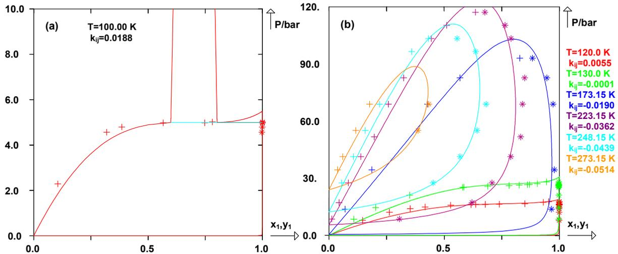
**Figure III-14 :** Diagrammes de phases prédits avec le modèle E-PPR78 pour le système CO(1)+2(2). (a) Diagramme isotherme à 100.00 K avec une ligne d'équilibre triphasique. (b) Isothermes à différentes températures. (+) : Points de bulle expérimentaux, (\*) : points de rosée expérimentaux.
