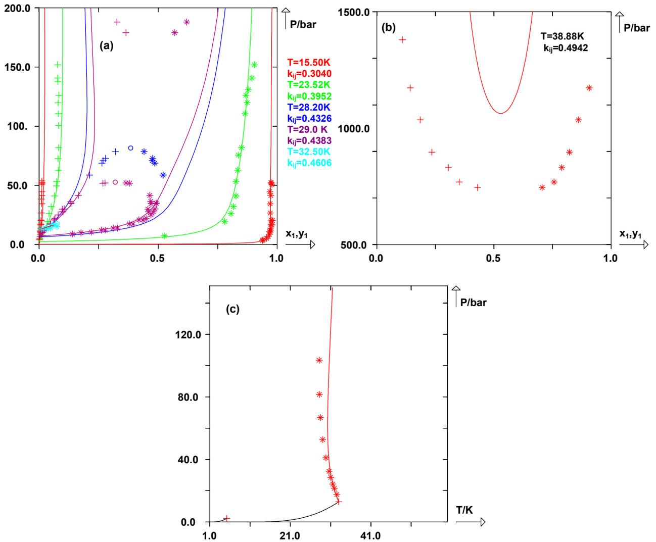
**Figure III-9 :** (a),(b) : Diagrammes de phase pour le système He(1)+H<sub>2</sub>(2) prédits par le modèle E-PPR78 à différentes températures. (+) : Points de bulle expérimentaux, (\*) : points de rosée expérimentaux, (o) : points critiques.
