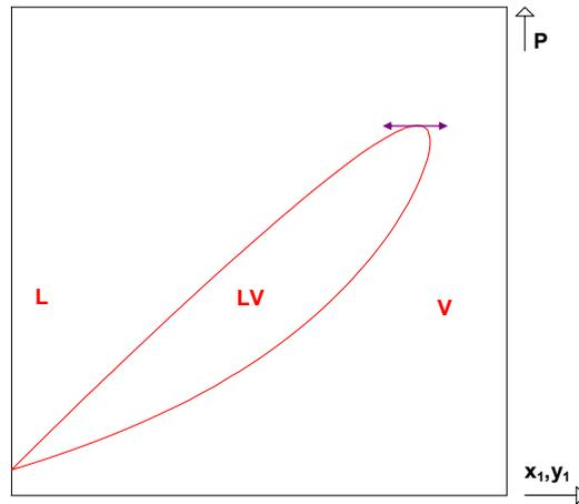
**Figure I-2 :** Exemple de point critique sur un diagramme de phase dans le plan  $Pxy$ . Le point critique est marqué par la double flèche. L : domaine liquide, V : domaine vapeur, LV : domaine liquide-vapeur.
