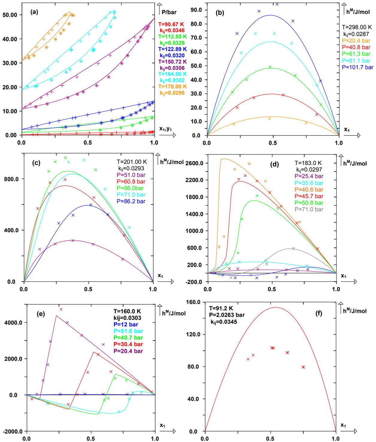
**Figure III-20** : Diagrammes de phase prédits avec le modèle E-PPR78 pour le système Ar(1)+CH<sub>4</sub>(2).
