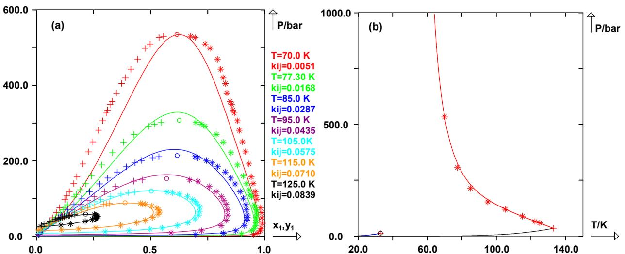
**Figure III-17 :** Diagrammes de phase prédits pour le système H<sub>2</sub>(1)+CO(2) avec le modèle E-PPR78.
