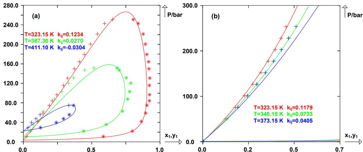
**Figure III-23 :** Diagrammes de phase prédits avec le modèle E-PP78 pour deux systèmes : (a) Ar(1)+22m3(2), (b) Ar(1)+224m5(2). (+) : Points de bulle expérimentaux, (\*) : points de rosée expérimentaux.
