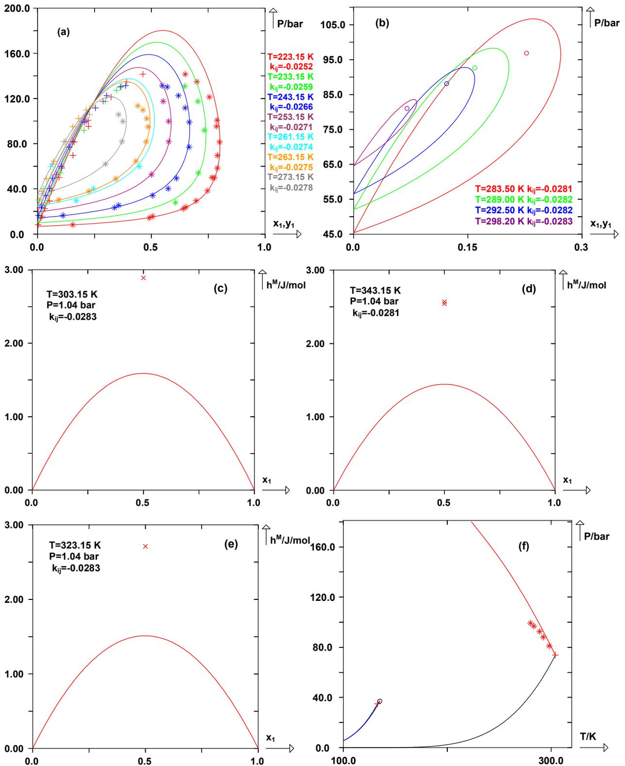
**Figure III-15 :** Diagrammes de phase prédits par le modèle E-PPR78 pour le système CO(1)+CO<sub>2</sub>(2).
