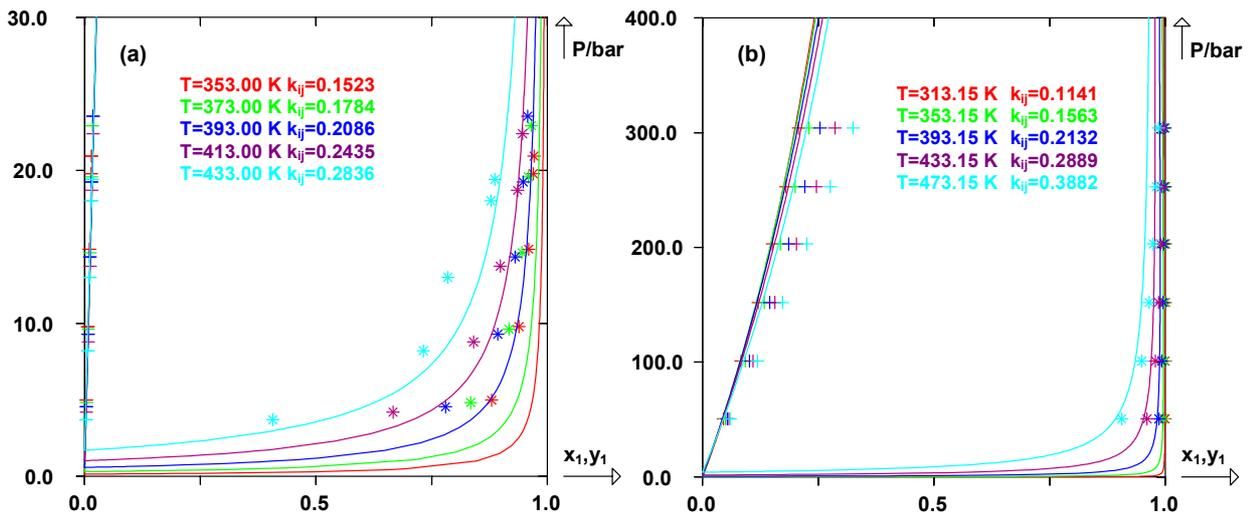
**Figure III-16 :** Diagrammes de phase prédits avec le modèle E-PPR78 pour (a) CO(1)+13mB(2) et (b) CO(1)+14mB(2) à différentes températures. (+) : Points de bulle expérimentaux, (\*) : points de rosée expérimentaux.
