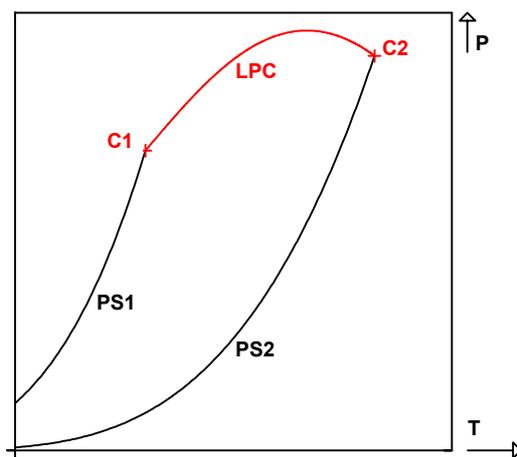
**Figure I-1** : Illustration du lieu des points critiques reliant les points critiques des corps purs 1 et 2 dans un mélange binaire. PS1 et PS2 : courbes de pression de vapeur saturante des corps purs 1 et 2.
