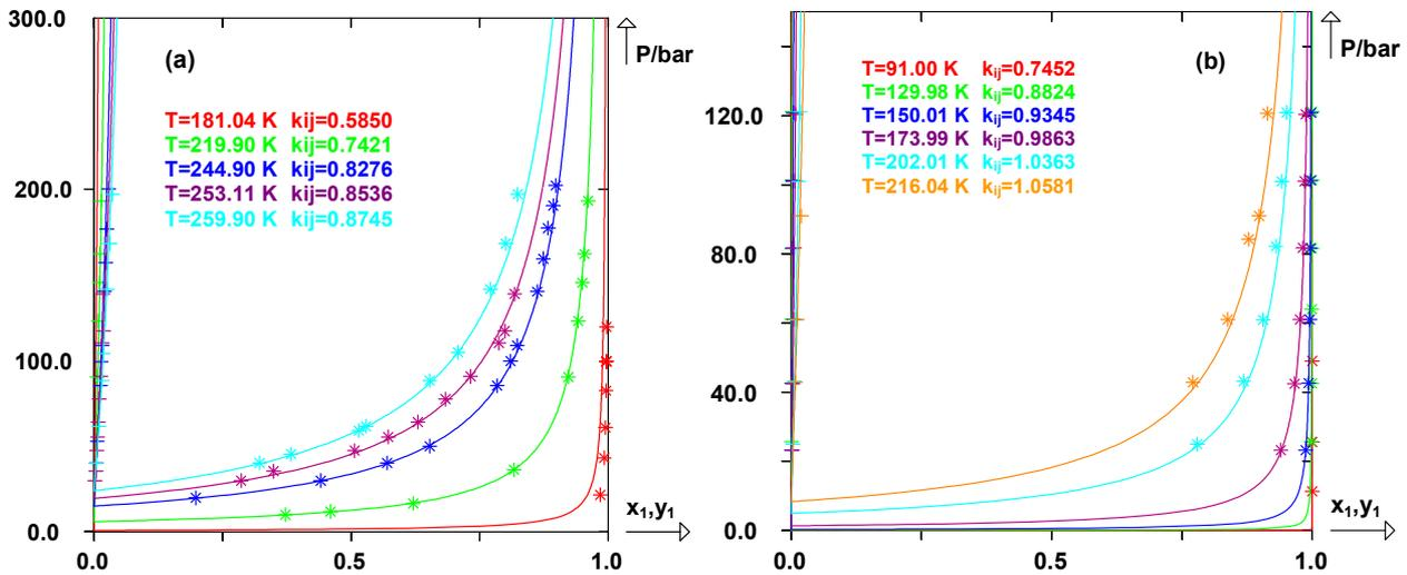
**Figure III-4** : Diagrammes de phase prédits par le modèle E-PPR78 pour He(1)+CO<sub>2</sub>(2) et He(1)+C<sub>2</sub>H<sub>4</sub>(2) à différentes températures. (a) : He(1)+CO<sub>2</sub>(2) et (b) : He(1)+C<sub>2</sub>H<sub>4</sub>(2). (+) : points de bulle expérimentaux, (\*) : points de rosée expérimentaux.
