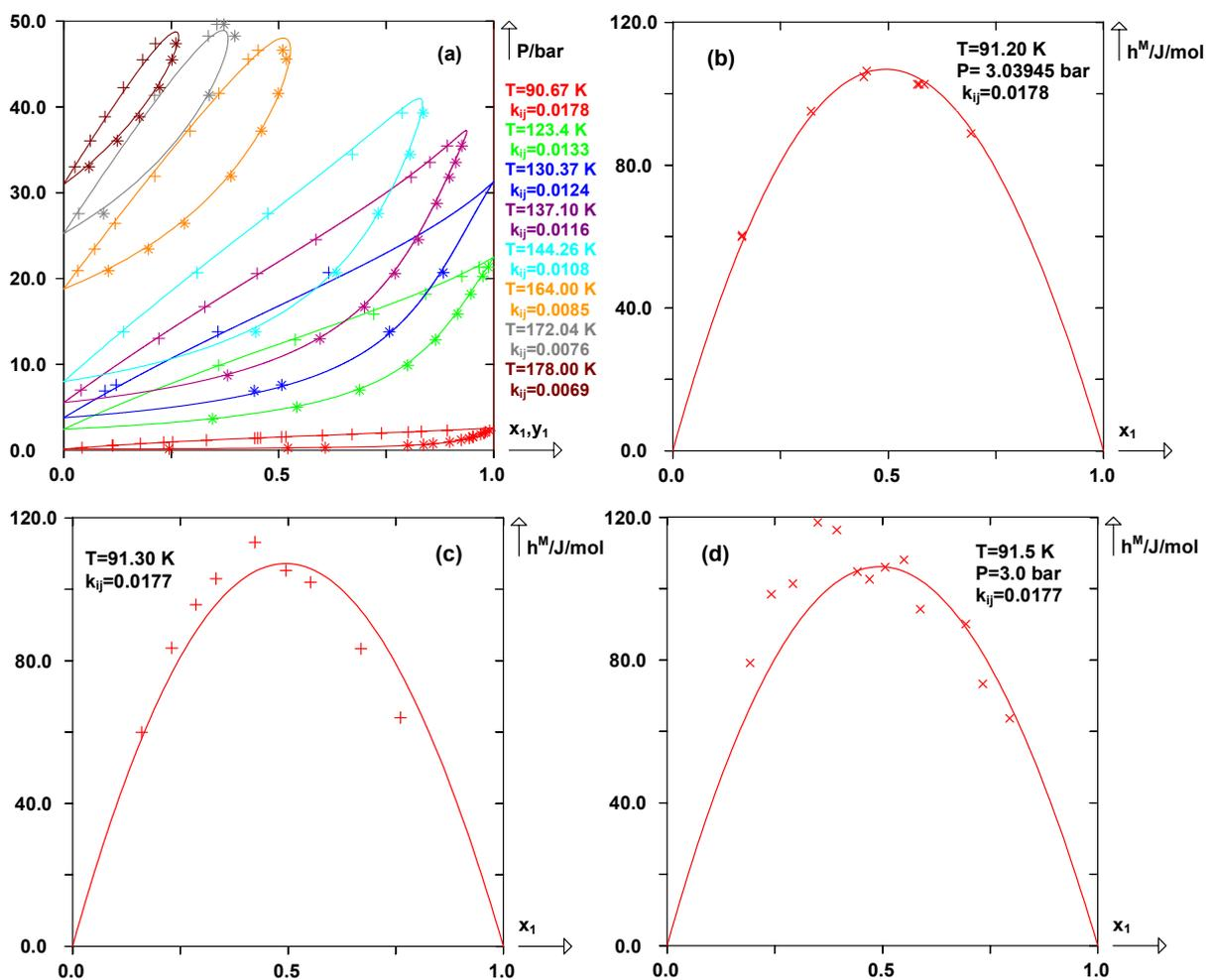
**Figure III-13 :** Diagrammes de phase et enthalpies de mélange prédits avec le modèle E-PPR78 pour le système CO(1)+CH<sub>4</sub>(2).
