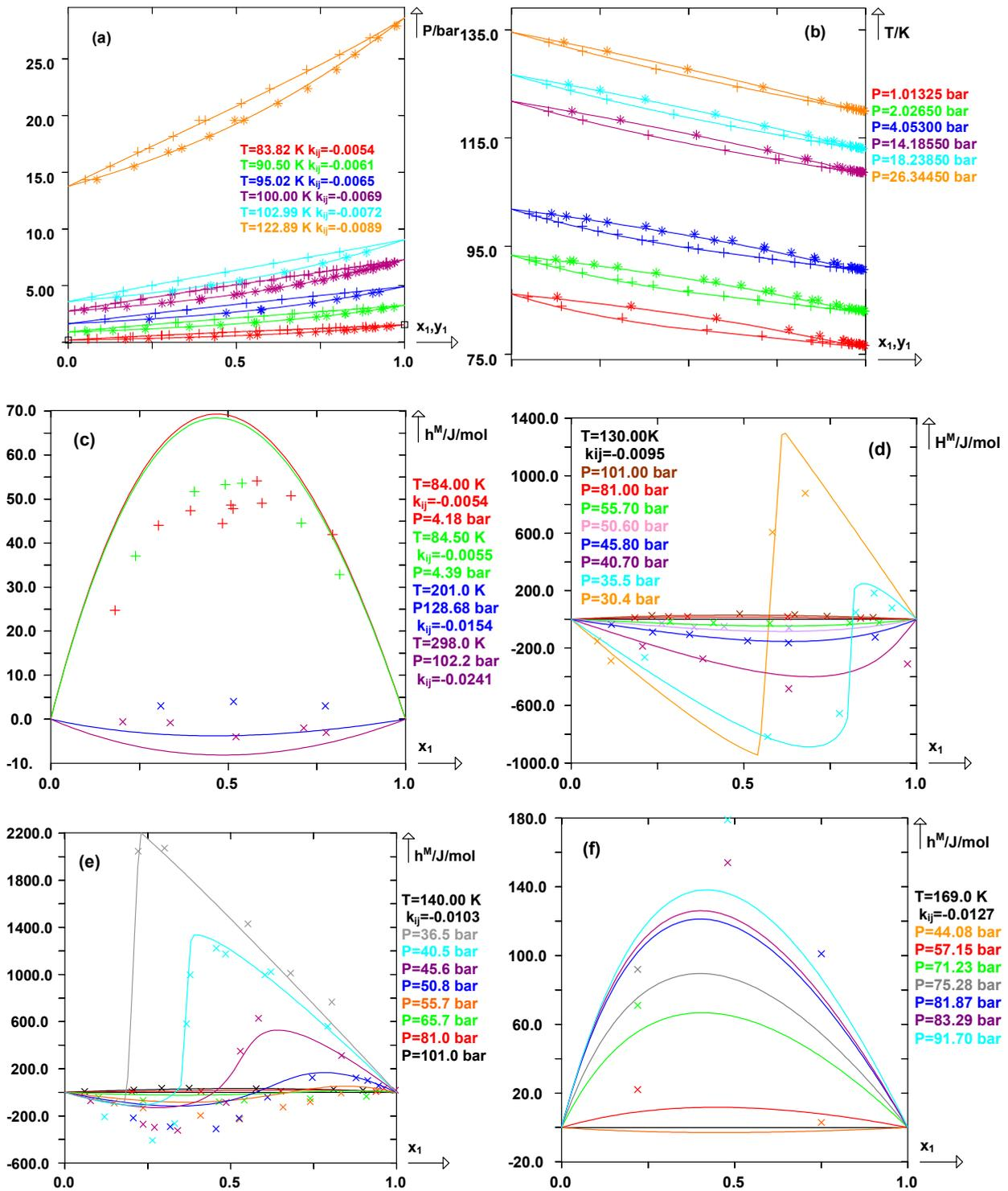
**Figure III-25 :** Diagrammes de phase et enthalpies de mélange prédis avec le modèle E-PPR78 pour  $N_2(1)+Ar(2)$ .
