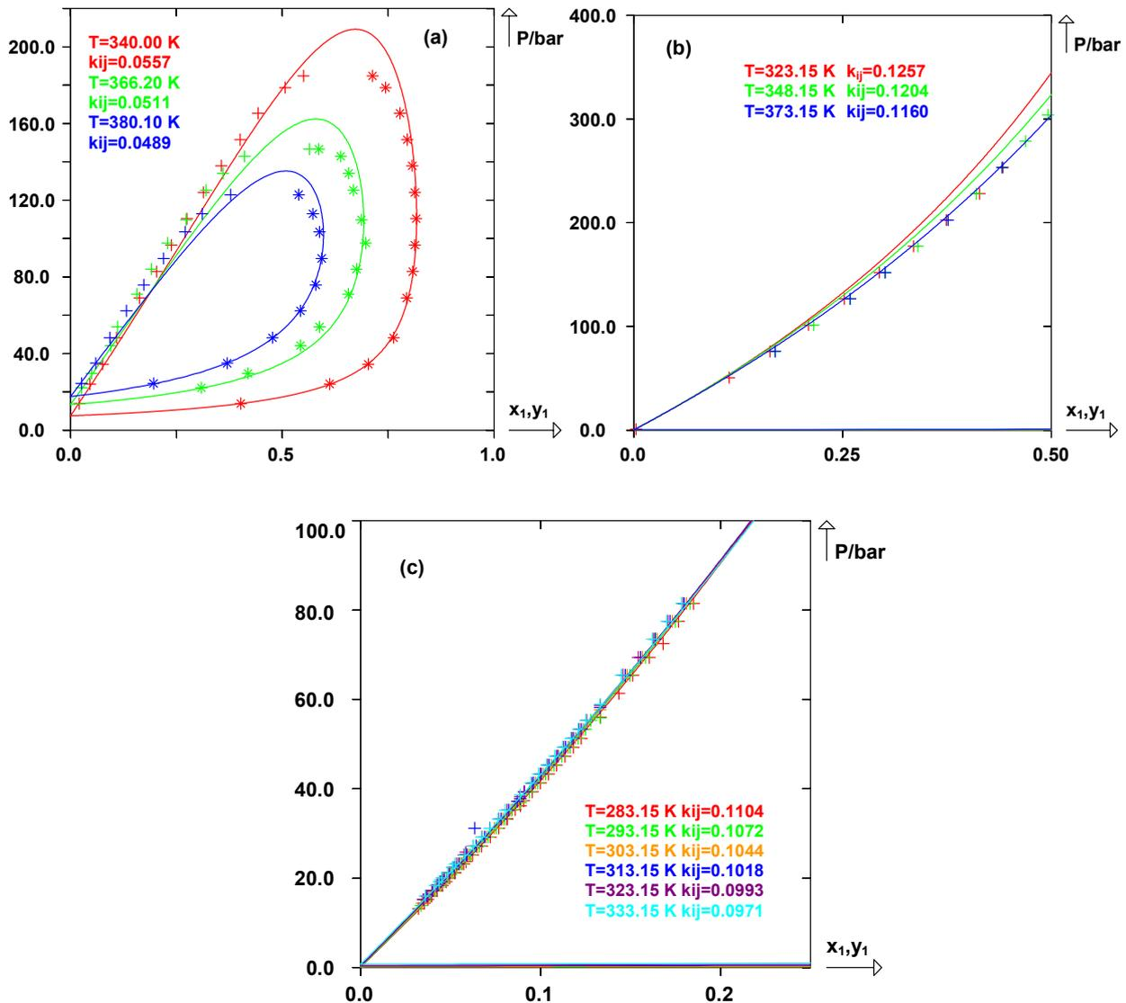
**Figure III-21 :** Diagrammes de phase prédits avec le modèle E-PPR78 pour les systèmes binaires contenant de l'argon et des alcanes linéaires. (a) Ar(1)+4(2), (b) Ar(1)+8(2), (c) Ar(1)+6(2). (+) : Points de bulle expérimentaux, (\*) : points de rosée expérimentaux.
