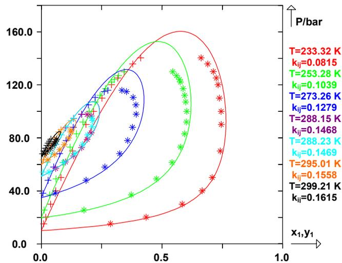
**Figure III-27 :** Diagrammes de phase calculés avec le modèle E-PPR78 pour Ar(1)+CO<sub>2</sub>(2). (+) : Points de bulle expérimentaux, (\*) : points de rosée expérimentaux.
