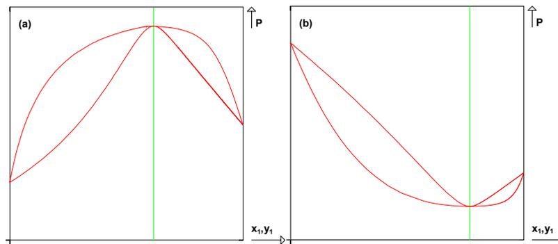
**Figure I-3 :** Exemples de diagrammes de phase isothermes présentant un azéotrope dans le plan  $Pxy$ . La composition azéotrope est marquée par la ligne verte. (a) : azéotrope positif, (b) : azéotrope négatif.
