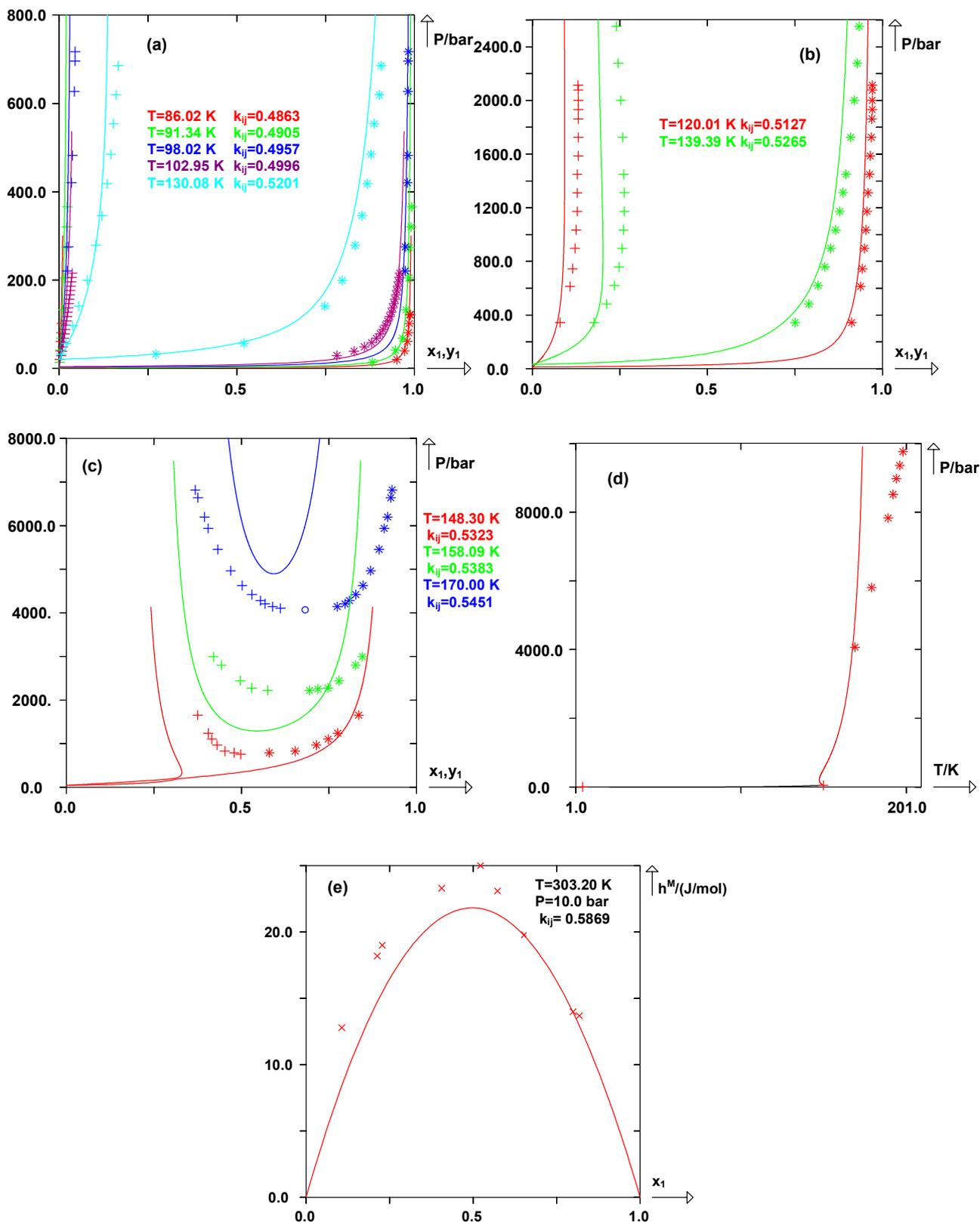
**Figure III-5 :** Diagrammes de phase et enthalpies de mélange prédites avec le modèle E-PPR78 pour He(1)+Ar(2). (a),(b) et (c) : diagrammes de phase obtenus à différentes températures. (+) : Points de bulle expérimentaux, (\*) : points de rosée expérimentaux, (O) : points critiques.
