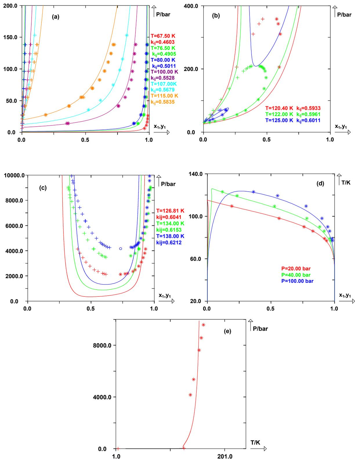
**Figure III-6 :** Diagrammes de phase prédits par le modèle E-PPR78 pour He(1)+N<sub>2</sub>(2).
