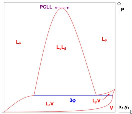
**Figure I-24 :** Diagramme de type VI dans le plan  $Pxy$ . On se place ici à une température entre  $T(\text{PCTI})$  et  $T(\text{PCTS})$ . PCLL : Point critique liquide-liquide. Ce point apparaît lorsque la température atteint celle du point critique terminal inférieur, puis disparaît lorsqu'elle atteint celle du point critique terminal supérieur.
