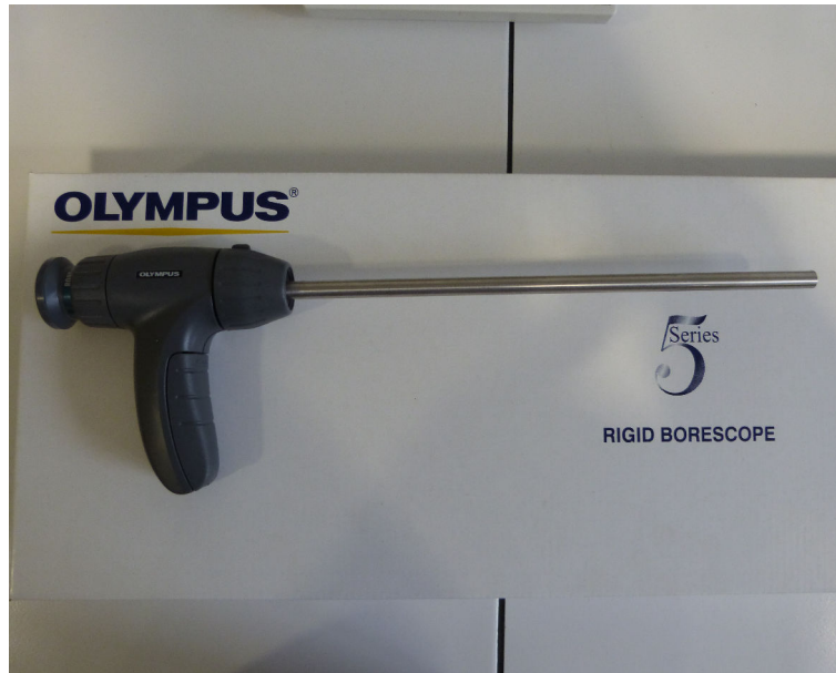
FIGURE 4.7 – Photographie du borescope utilisé pour l’observation in-situ.
