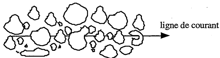
Figure IV.3: Structure d'un écoulement turbulent
