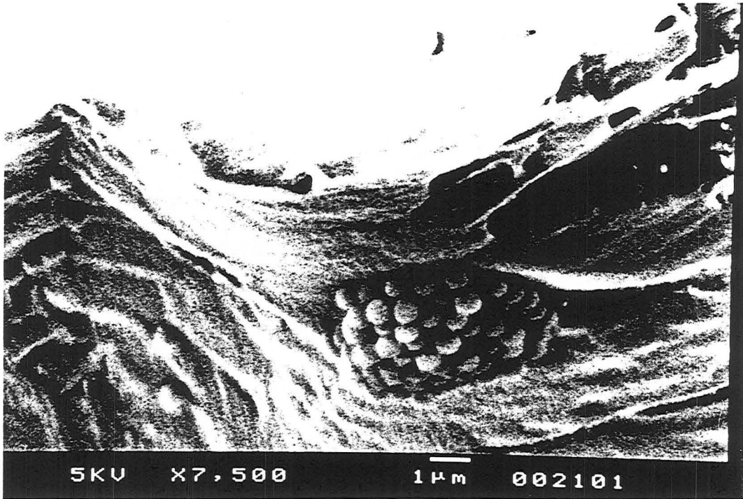
Photo 3.5 Particules de latex ( 0,79 \mu\text{m} ) et agglomérats adsorbés sur les types 1 et 2 surfaciques (expérience à 10^{-1} M NaCl - 10 mg/l de latex)
