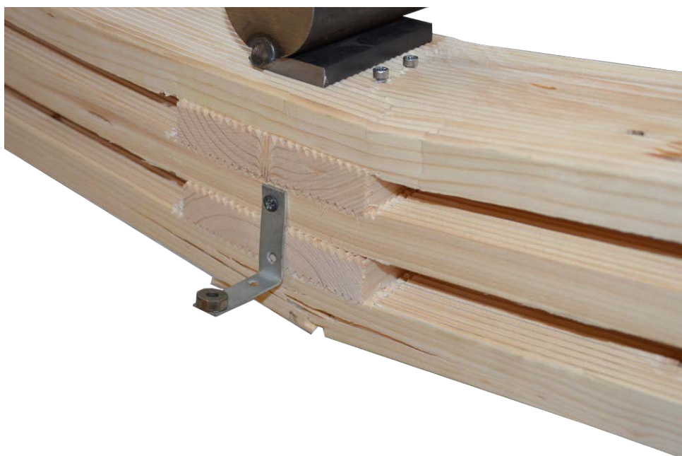
FIGURE 10.12 – Poutre 2 : Rupture en compression de la lamelle supérieure puis en traction de la lamelle inférieure
