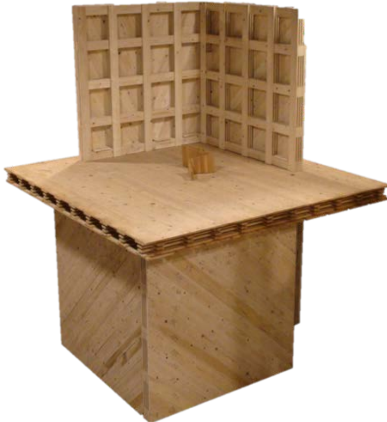
FIGURE 1.13 – Parois assemblées par tourillons soudés
