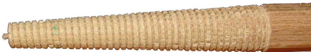
FIGURE 8.2 – Vis usinée sur un mini-tour à commande numérique
