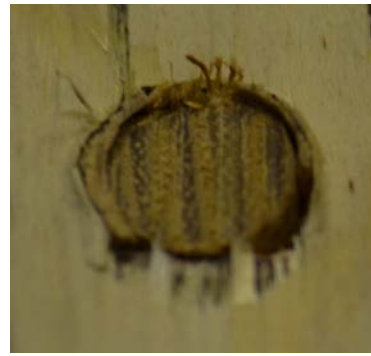
(b) Rupture du filet en cisaillement
