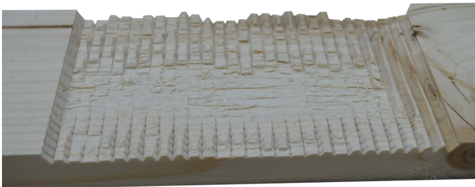
FIGURE 7.23 – Problème d'usinage d'une denture transversale au fil du bois
