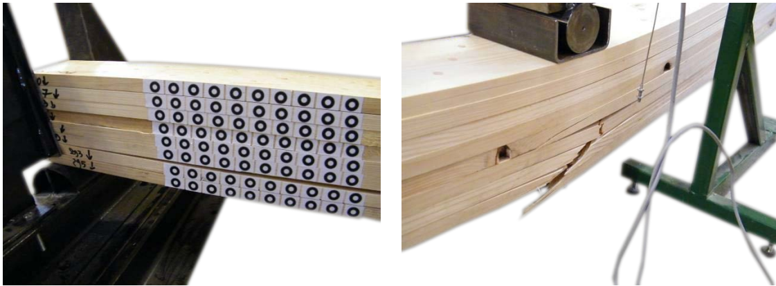
(a) Rupture des tourillons en cisaillement (b) Rupture des lamelles en flexion et traction combinée
