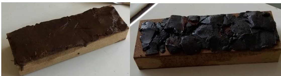
Figure 10: Eprouvettes de panneaux de MDF recouvert de matériaux polyuréthanes à base de tannins (à gauche: de Mimosa, à droite: de Quebracho) appliqués difficilement à la spatule.
