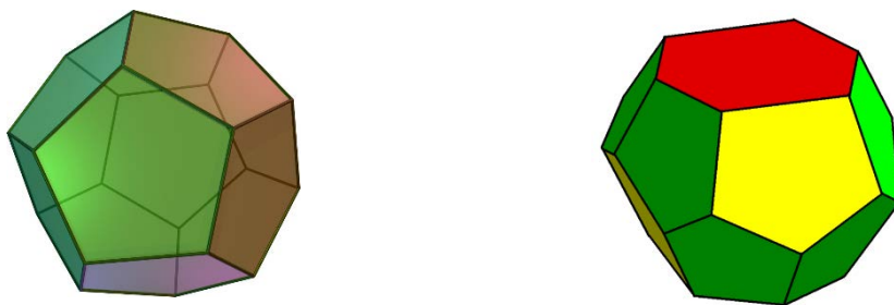
Figure 2: Structure tridimensionnelle d'une cellule de mousse:
