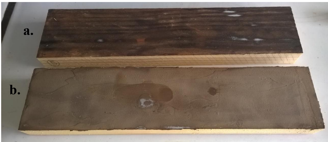
Figure 34: Essais d'application de produits de polyuréthanes à base de tannins de châtaignier en tant que finition: (a) avec une solution plus diluée dans le diméthyle carbonate; (b) avec cette même solution à laquelle on a rajouté 5% de pigments blancs et 10% de microfibrilles de cellulose.
