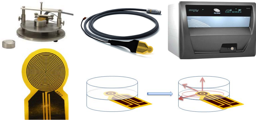
Figure 18: Appareil HotDisk TPS 2500 et détails de la sonde de mesure.
