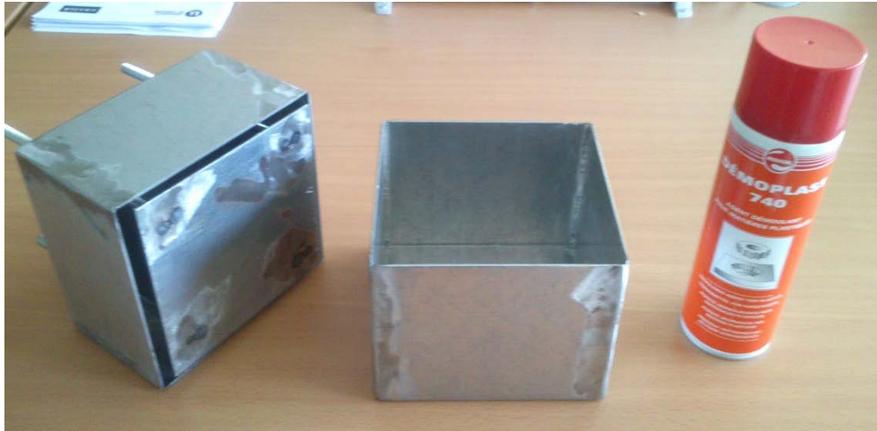
Figure 16: Boîte métallique 15 cm X 15 cm (au centre) et son couvercle avec un système réglable d'épaisseur (à gauche), et un produit de démoulage en spray (à droite).
