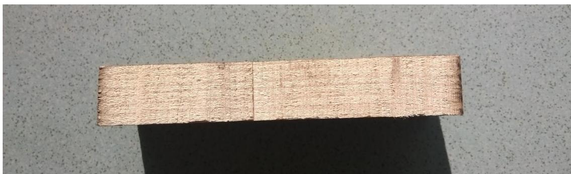
*Figure 30: Coupe transversale de la pièce d'épicéa imprégnée.*
