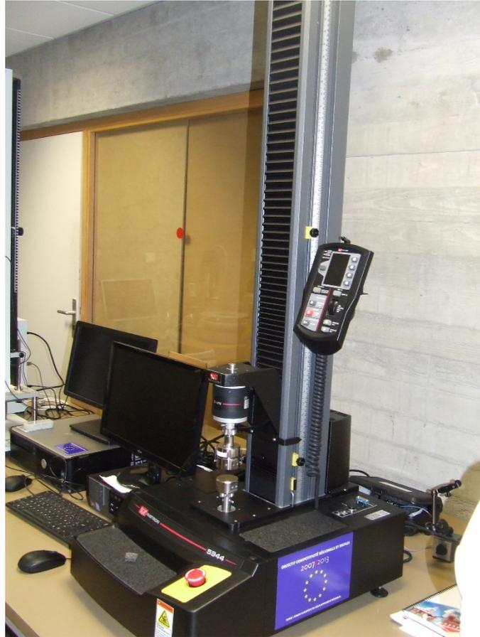
*Figure 19: Machine d'essais universelle Instron 5944.*
