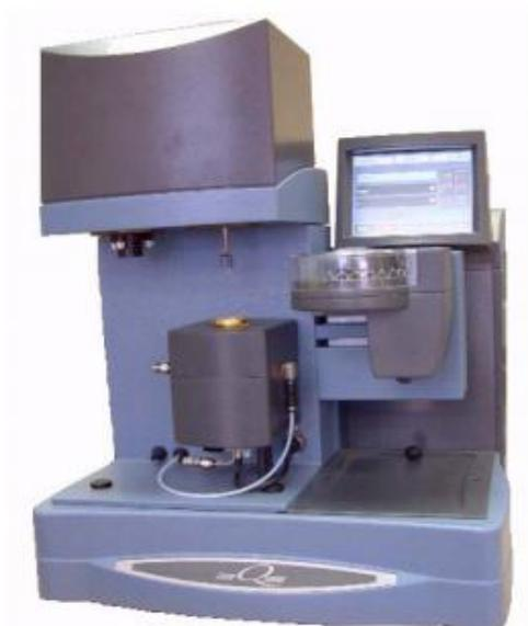
*Figure 9: Appareil de mesure thermogravimétrique.*
