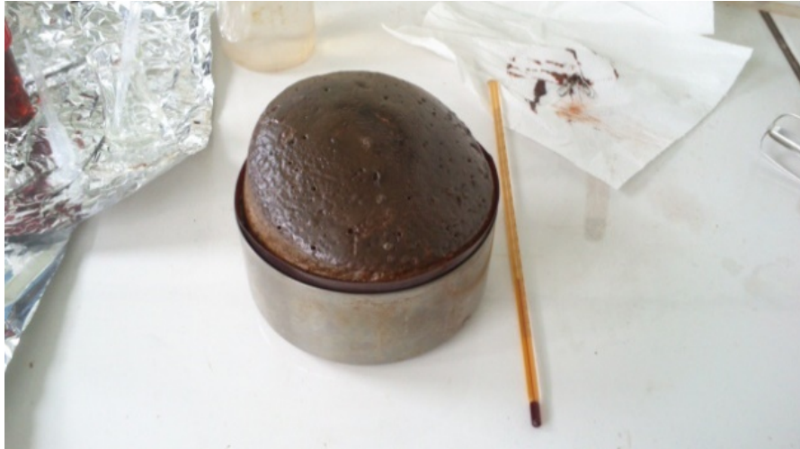
Figure 14: Pain de mousse après expansion dans le cristalliseur métallique dont les bords intérieurs ont été recouverts d'une feuille de silicone. On remarque un léger retrait radial dû à l'abaissement de température, alors que la mousse n'a pas encore tout à fait durci.
