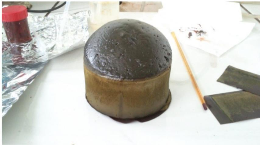
*Figure 15: Pain de mousse après démoulage ; le silicone se détache très bien du matériau, contrairement au métal du cristalliseur, qui aurait entraîné un écorchage hasardeux de la mousse pour l'y extraire.*
