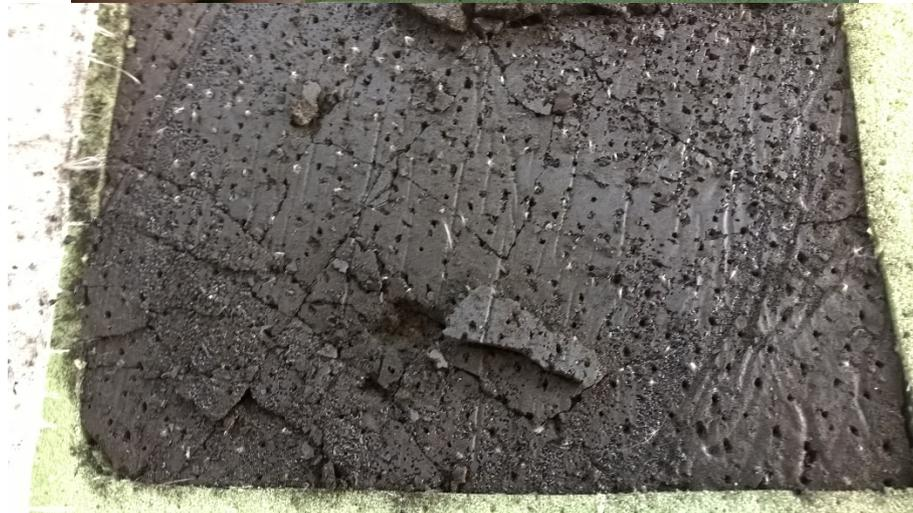
*Figure 52: Aspect d'un élément de panneau de mousse de tannins après passage dans l'aiguilleuse NAPCO, en enlevant le mat de non-tissé: le matériau est partiellement détruit.*
