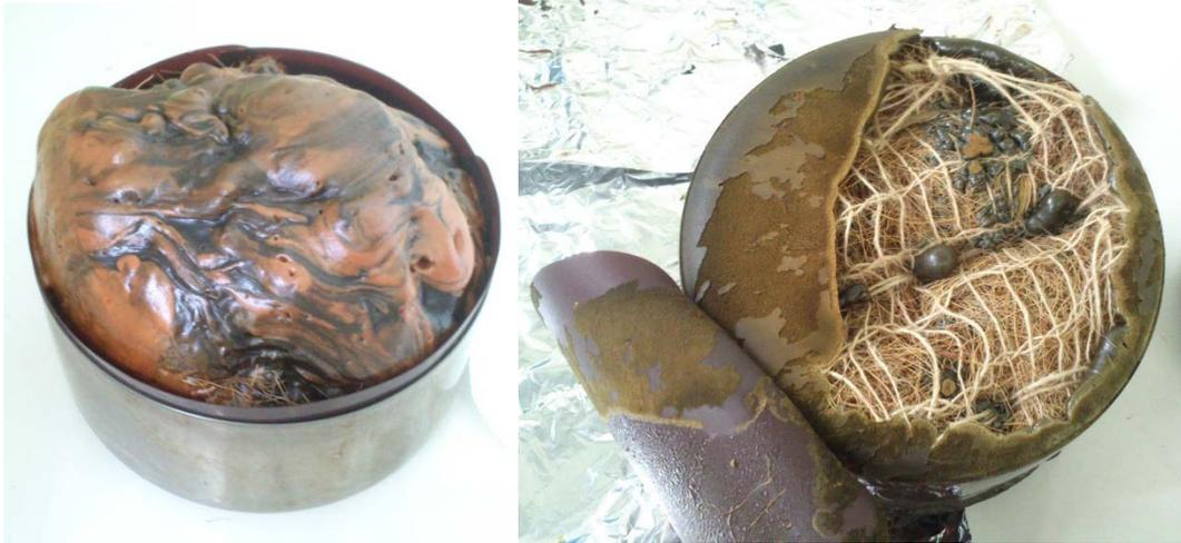
*Figure 35: Essai d'injection de résine moussante (formulation n°4) par dessus un mat de fibres de coco cardé. A gauche, la mousse en expansion durcit inégalement (la couleur brune est encore visco-élastique, la couleur noire est plus rigide). A droite, la résine s'est introduite de façon très irrégulière à travers les fibres.*
