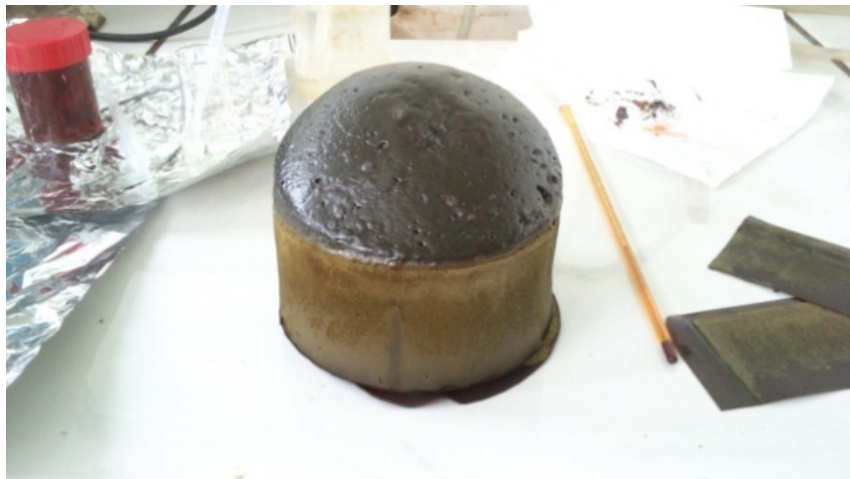
Figure 15: Pain de mousse après démoulage ; le silicone se détache très bien du matériau, contrairement au métal du cristalliseur, qui aurait entraîné un écorchage hasardeux de la mousse pour l'y extraire.
