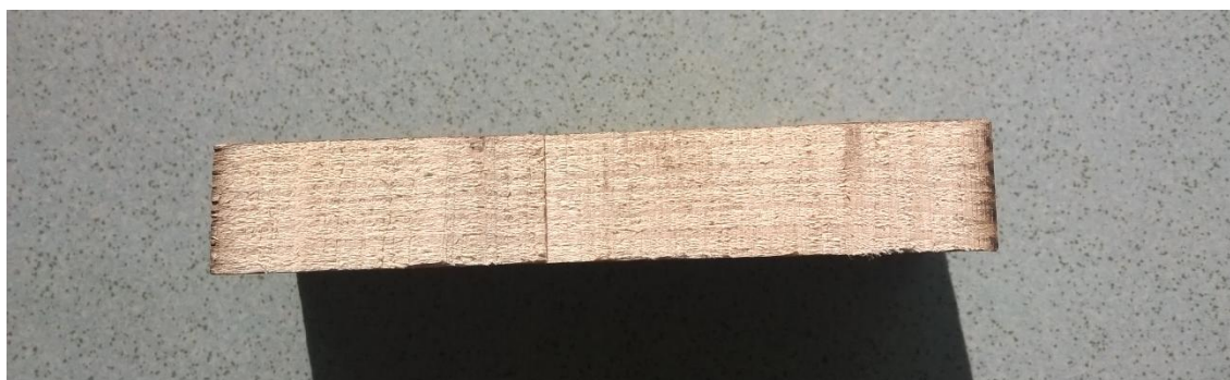
Figure 30: Coupe transversale de la pièce d'épicéa imprégnée.
