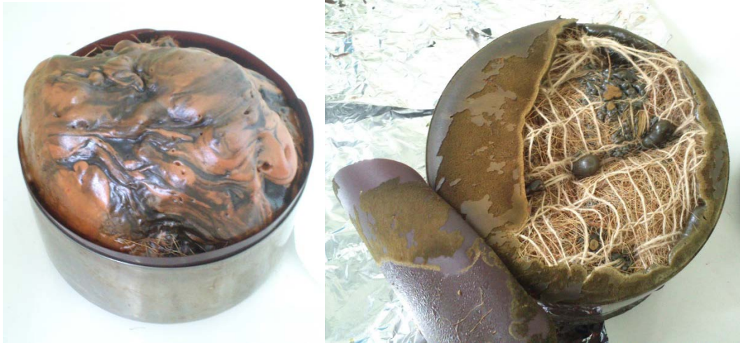
Figure 35: Essai d'injection de résine moussante (formulation n°4) par dessus un mat de fibres de coco cardé. A gauche, la mousse en expansion durcit inégalement (la couleur brune est encore visco-élastique, la couleur noire est plus rigide). A droite, la résine s'est introduite de façon très irrégulière à travers les fibres.
