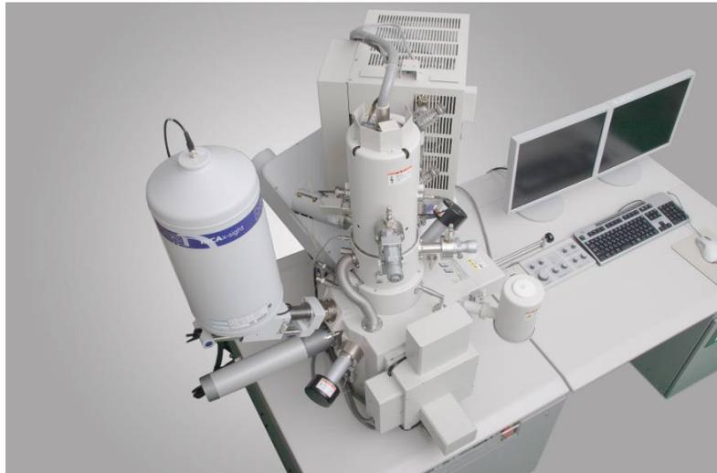
Figure 21: Microscope électronique à balayage FEI Quanta 600.
