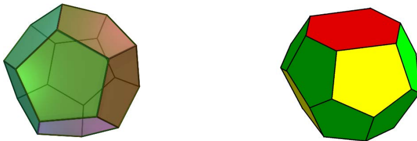
Figure 2: Structure tridimensionnelle d'une cellule de mousse:
