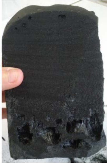
Figure 24: La mousse (formulation n°3) semble homogène dans son ensemble sauf à sa base ; l'évaporation et la dilatation de l'agent moussant s'est produit plus rapidement que la phase de gel et de solidification de la résine, là où la température est la plus élevée au début. Il en résulte un gradient de densité vertical au sein du matériau.
