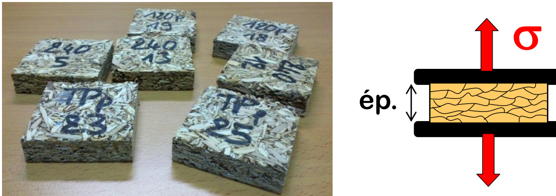
Figure 21: Echantillons de panneaux de particules (à gauche) destinés à être testés en cohésion interne sèche \sigma (schéma à droite)
