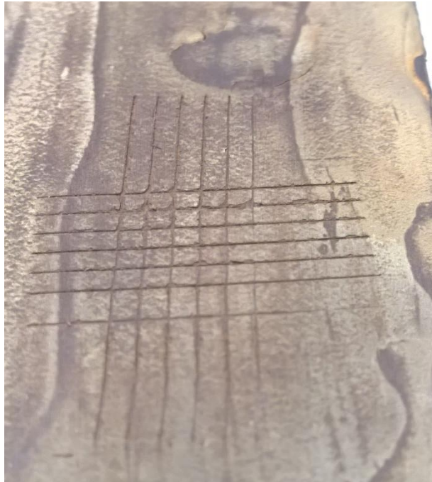
Figure 35: Test d'arrachement de la finition faite avec le produit polyuréthane à base de tannins de châtaignier avec 5% de pigments blancs et 10 % de microfibrilles de cellulose.
