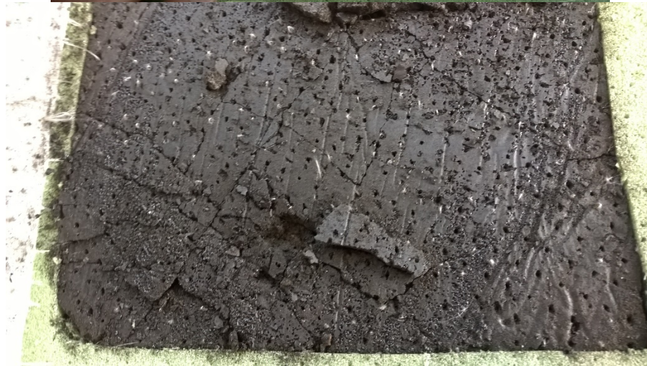
Figure 52: Aspect d'un élément de panneau de mousse de tannins après passage dans l'aiguilleteuse NAPCO, en enlevant le mat de non-tissé: le matériau est partiellement détruit.
