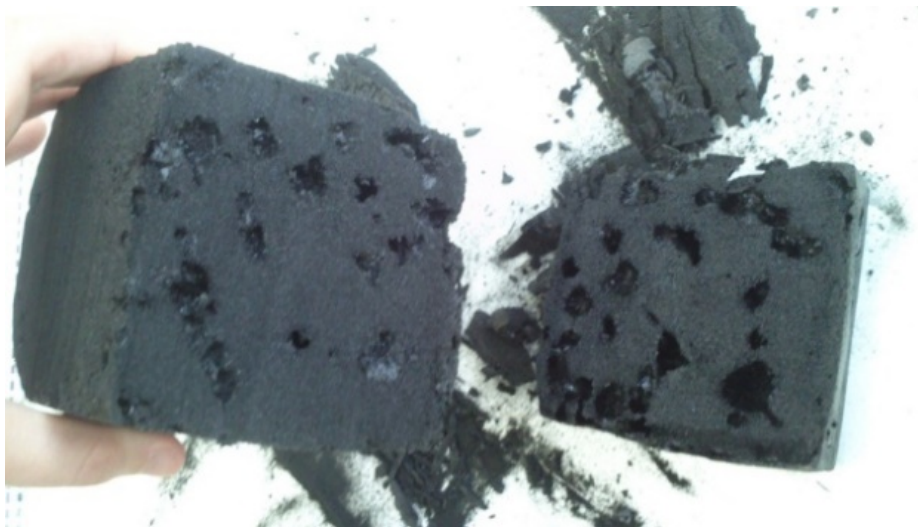
Figure 25: La mousse présente de gros trous dans l'ensemble de sa masse. La formulation ne permet pas une bonne homogénéisation de l'agent moussant au sein de la résine pendant la phase d'expansion ; il s'est alors aggloméré à différents endroits avant de s'évaporer, formant ces « poches » de gaz alors que la résine s'est mis à durcir.
