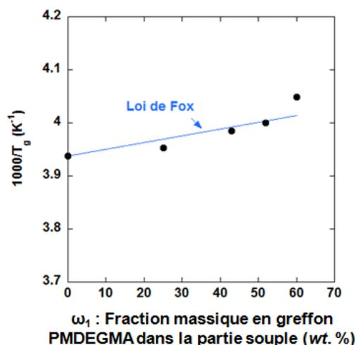
Figure 2-31 : Evolution de  $T_g$  en fonction de la fraction massique en greffons PMDEGMA dans le mélange des blocs souples JFAED 600 et de greffons PMDEGMA selon la loi de Fox
