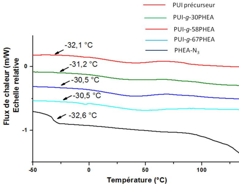
Figure 4-9 : Les thermogrammes des copolymères greffés, leur précurseur et les greffons PHEA-N<sub>3</sub> obtenus par MDSC
