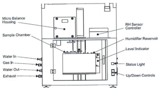
Figure 4-12 : Schéma de la configuration de l'appareil de mesure de sorption de vapeur d'eau à activité variable
