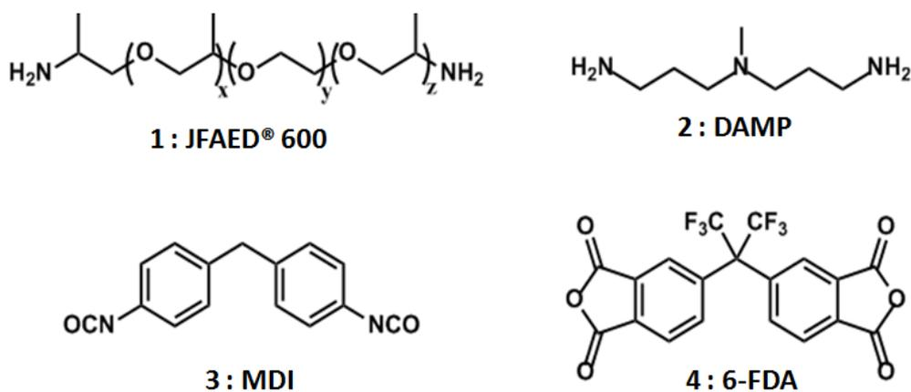
Figure 2-15 : Structure chimique des monomères du PUI précurseur
