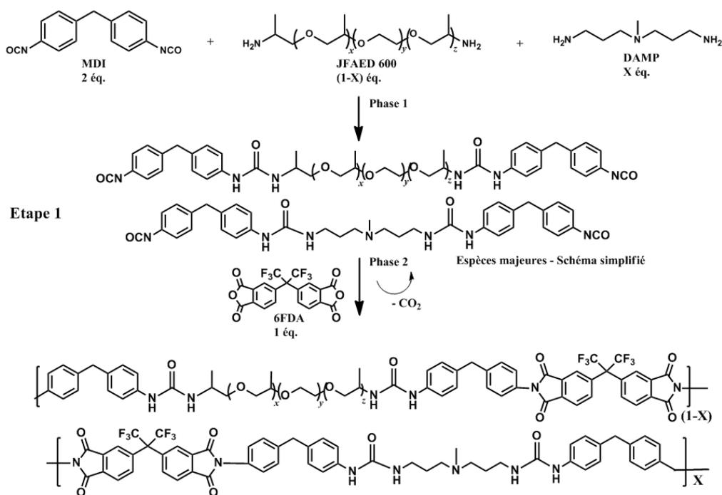
Figure 2-16 : Formation du PUI précurseur à partir des deux macrodiisocyanates par polycondensation (Etape 1 de la synthèse des copolymères greffés)
