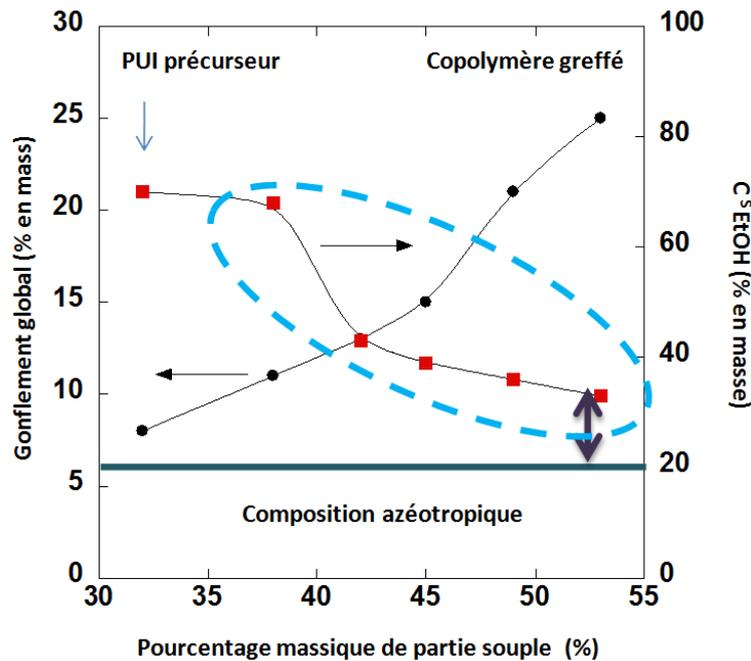
Figure 3-5 : Gonflement global et sélectivité de sorption en fonction de la fraction massique de la partie souple dans les copolymères greffés et leur précurseur pour le mélange azéotrope ETBE/EtOH à 30°C
