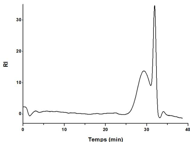
Figure 2-13 : Chromatogramme de PMDEGMA-N<sub>3</sub> dans DMF/LiCl
