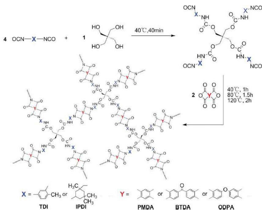
Figure II-8 : Exemple de préparation de PUIs hyperbranchés [51]
