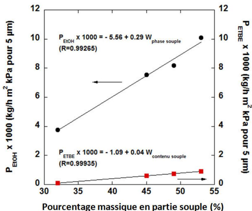
Figure 3-9 : Influence de la proportion massique de partie souple dans les copolymères greffés et leur précurseur sur les perméabilités partielles de l'éthanol et de l'ETBE lors de la séparation du mélange azéotrope ETBE/EtOH par pervaporation à 50°C
