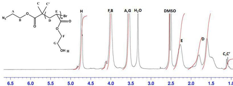
Figure 4-4 : Spectre RMN <sup>1</sup>H de PHEA-N<sub>3</sub> après la purification dans DMSO-d<sub>6</sub> 300MHz
