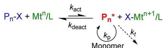
Figure 2-3: Schéma de mécanisme de l'ATRP [4]
