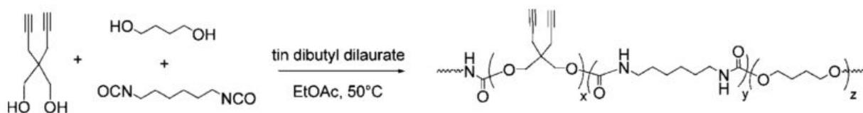
Figure 1-15 : Exemple de synthèse de PUs « clickables » par l'incorporation des fonctions « clickables » dans les blocs rigides[92]
