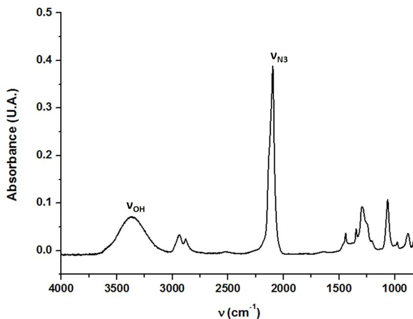
Figure 2-7 : Spectre IR du 2-azido-1 ethanol
