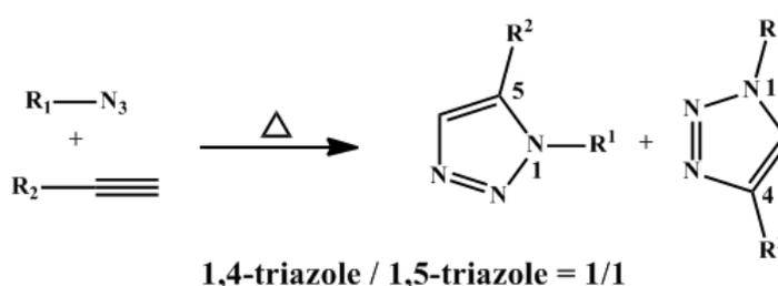
Figure 1-11 : la cycloaddition Huisgen 1,3-dipolaire non catalysée
