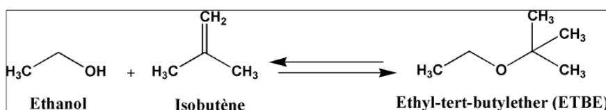
Figure 1-12 : Schéma de production de l'ETBE
