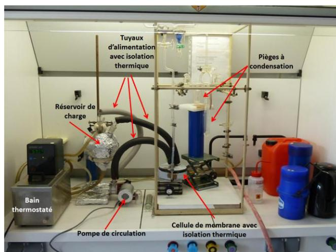
Figure 3-6 : Le dispositif de pervaporation utilisé
