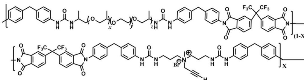
Figure 2-20 : Structure chimique du motif de répétition du PUI « clickable » (x=0.3)
