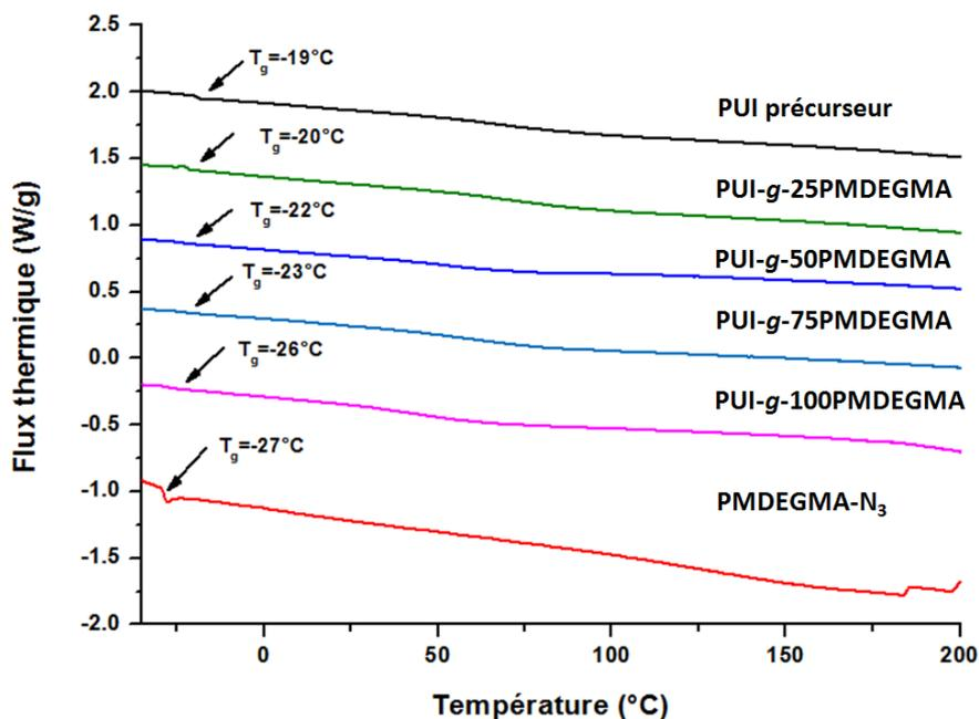
Figure 2-29 : Thermogrammes des polymères obtenus par MDSC
