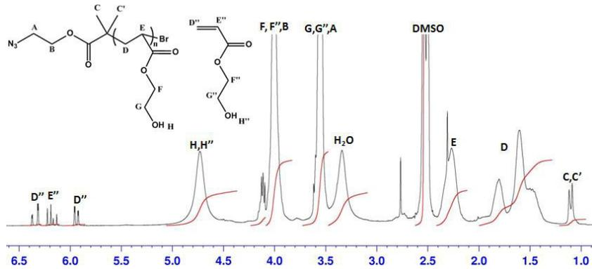
Figure 4-3 : Spectre RMN <sup>1</sup>H de PHEA-N<sub>3</sub> avant purification dans DMSO-d<sub>6</sub> 300 MHz
