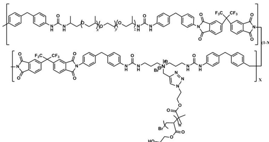
Figure 4-22 : Structure des copolymères greffés PUI-g-PHEA
