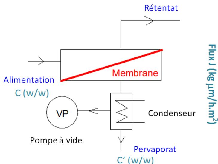
Figure 3-1 : Schéma de principe de la pervaporation
