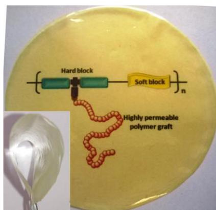
Figure 2-28 : Exemple de film de PUI greffé à l'état sec
