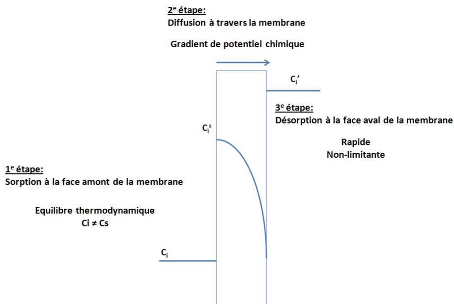
Figure 3-2 : Représentation schématique du modèle de sorption-diffusion
