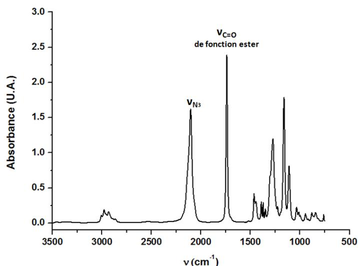
Figure 2-9 : Spectre IR de l'amorceur fonctionnalisé AEBriB
