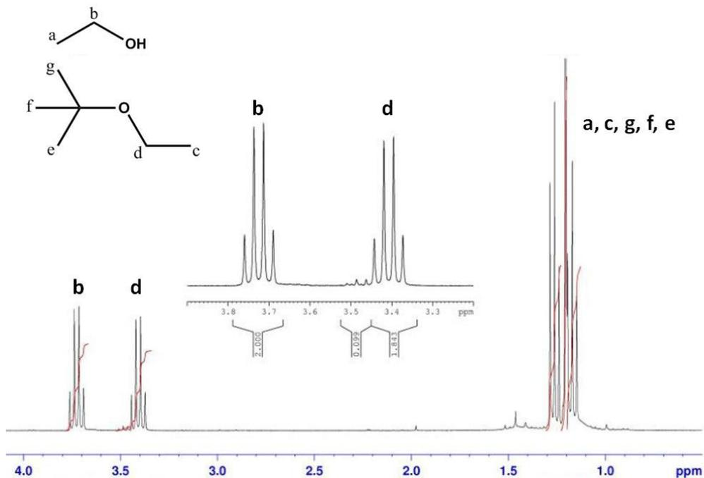
Figure 3-4 : Exemple de spectre RMN <sup>1</sup>H du liquide désorbé dans CCl<sub>4</sub> (300 MHz, CDCl<sub>3</sub>)
