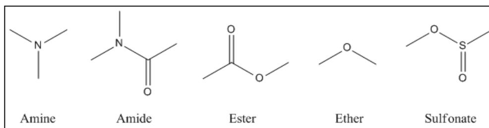
Figure 3-3 : Exemples des groupements accepteurs de liaisons hydrogène utilisés pour l'élaboration de membranes de pervaporation pour séparer les mélanges protique/aprotique[39]
