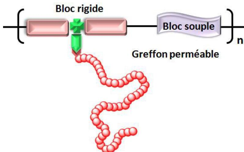
Figure 2-1 : Structure schématique des copolymères greffés ciblés
