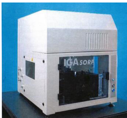
Figure 4-11 : Présentation de l'appareil de mesure IGA SORP pour les études des propriétés de sorption dans la vapeur d'eau à activité variable
